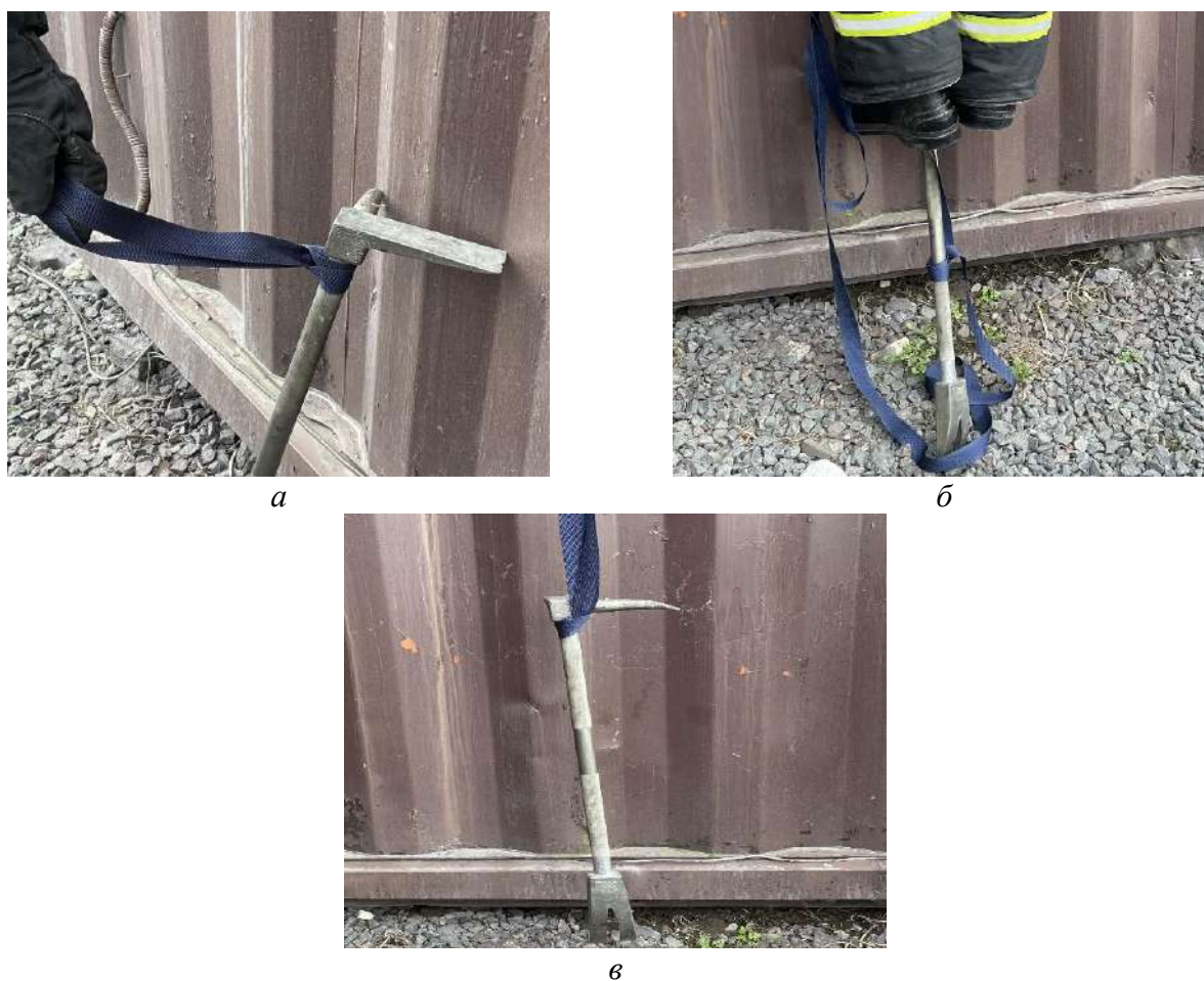
Рисунок 1 – Использование лома «Хулиган» для преодоления препятствий
