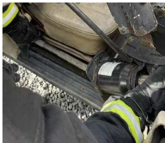
Рисунок 6 – Использование лома «Хулиган» в качестве упора под домкрат
