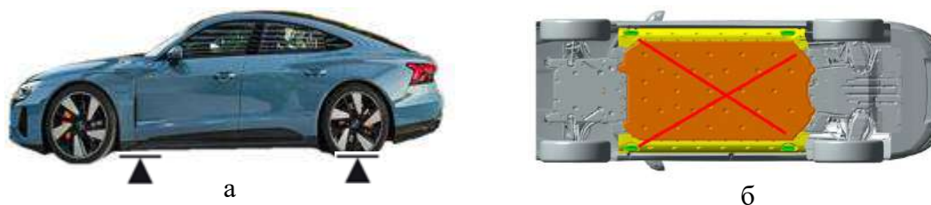
Рисунок 1 – Определение мест установки домкратов и ступенчатых упоров
