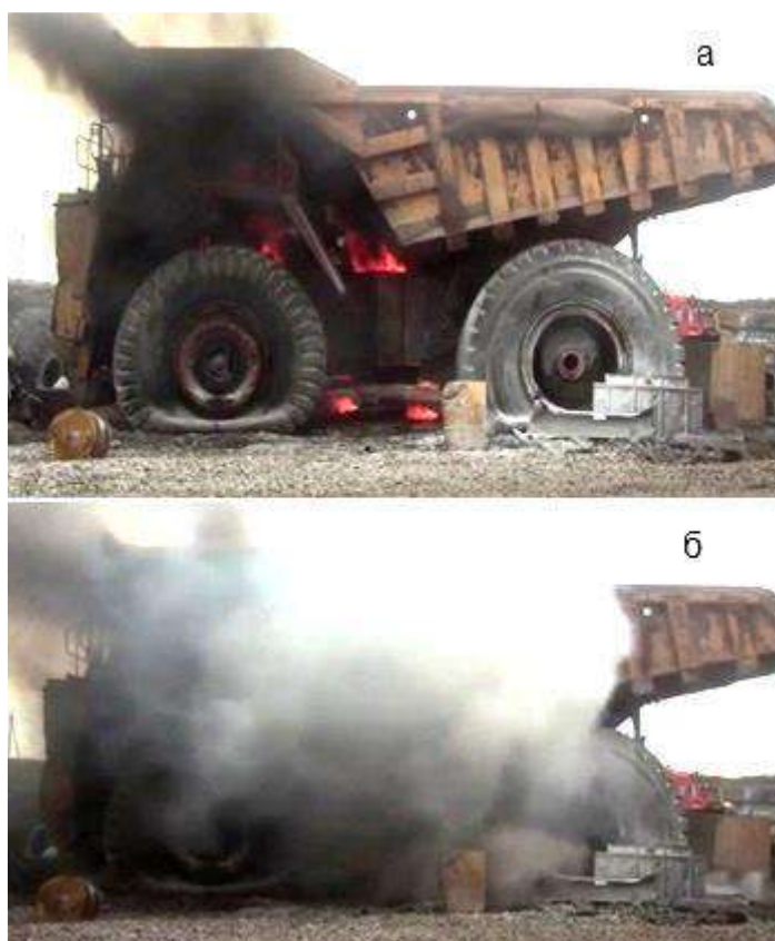
Рисунок 3 – Испытания по применению АСОТП от ЭПОТОС на карьерном самосвале БелАЗ [6]: а – начало огневых испытаний; б – завершение тушения модельного пожара через несколько секунд подачи огнетушащих веществ из системы АСОТП.
