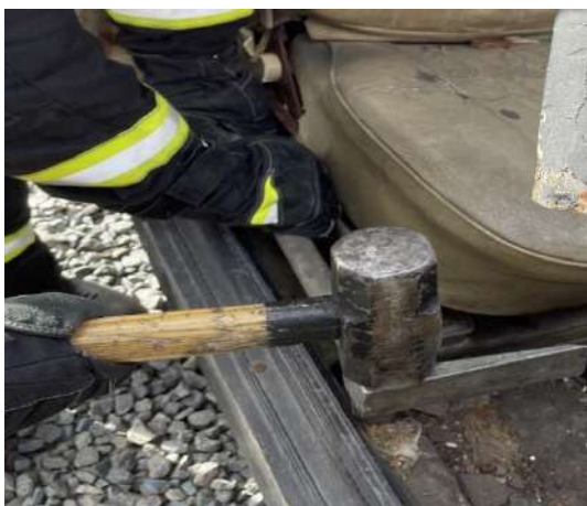
Рисунок 6 – Использование лома «Хулиган» в качестве упора под домкрат
