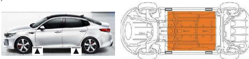
Рисунок 2 – Запрещенные и разрешенные места установки домкрата и упоров
