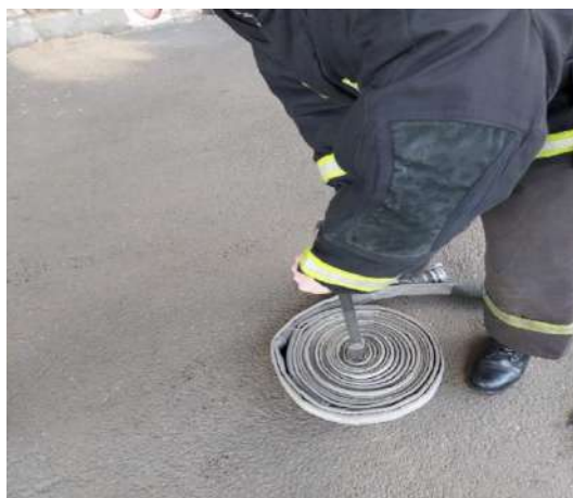
Рисунок 5 – Сматывание рукава в двойную скатку при помощи лома «Хулиган»
