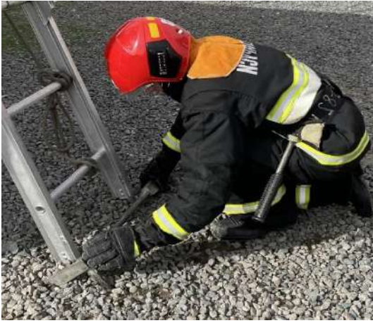
Рисунок 2 – Фиксация выдвжной трёхколенной лестницы (Л-3К) при помощи лома «Хулиган»
