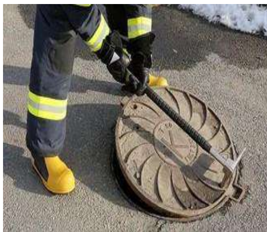
Рисунок 7 – Использование лома «Хулиган» для открытия люков пожарных гидрантов (ПГ)
