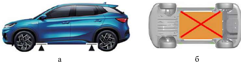
Рисунок 1 – Определение мест установки домкратов и ступенчатых упоров
