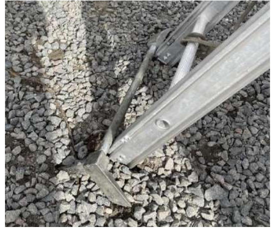
Рисунок 2 – Фиксация выдвжной трёхколенной лестницы (Л-3К) при помощи лома «Хулиган»
