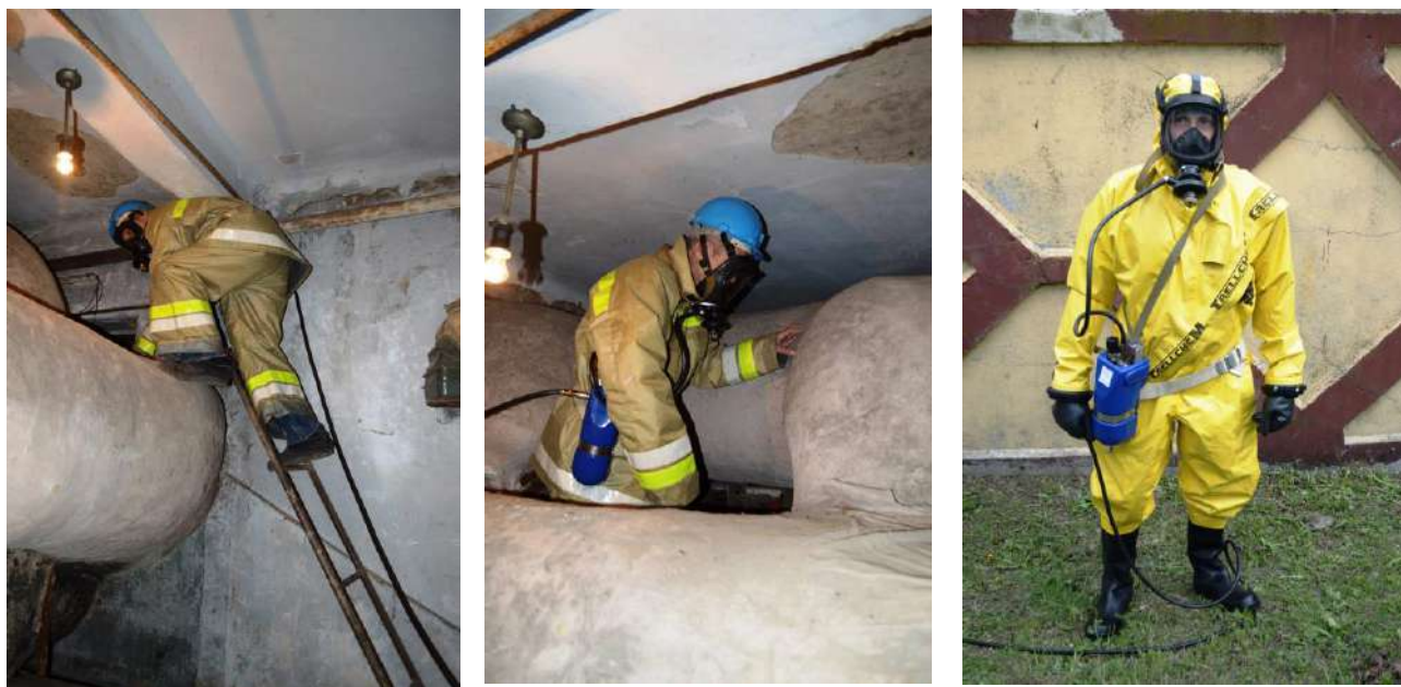
Рисунок 2. Натурные испытания дыхательного аппарата АДВП
