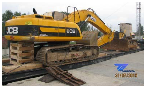
Рисунок 1 – Погрузка техники на железнодорожную платформу на станции оборудованной стационарной эстакадой (рампой)
