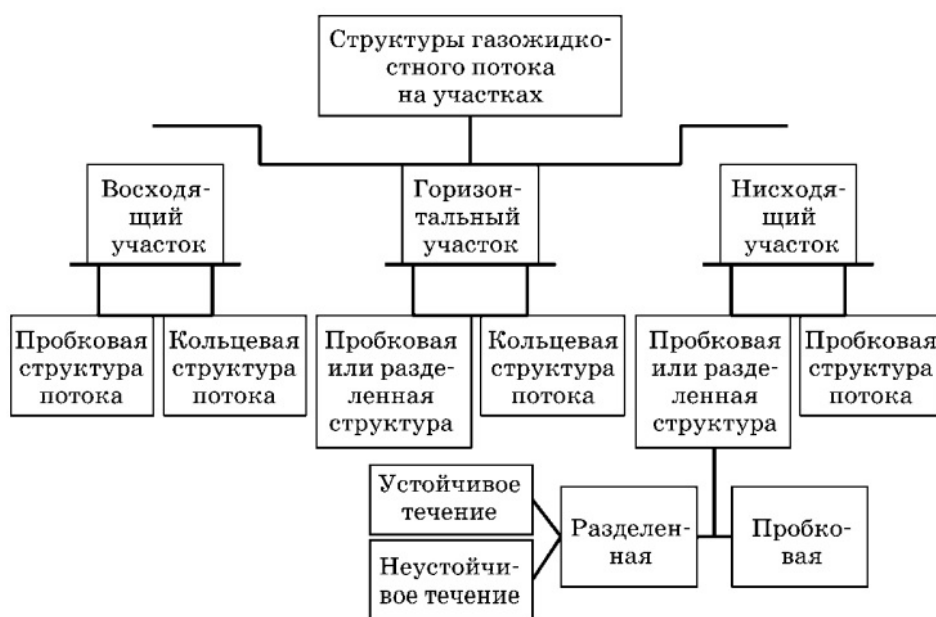
Рис. 1. Структурные формы двухфазного газожидкостного потока в трубопроводе [5]
