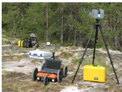
Рис.3 Инженерные исследования с использованием георадара
