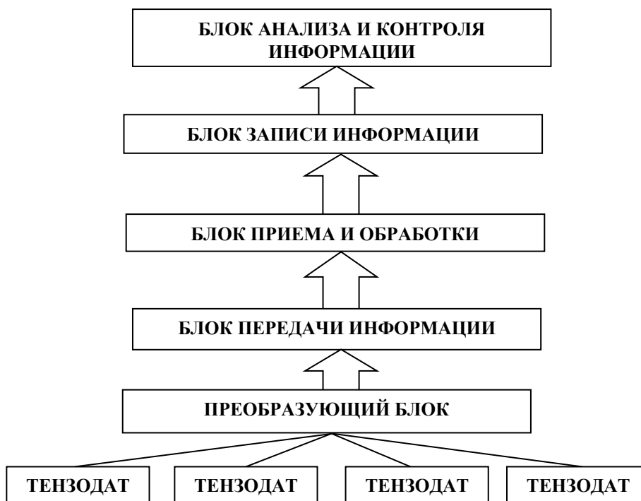
Рис. 2. Структура системы непрерывного мониторинга
