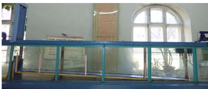
Рисунок 1 – Общий вид экспериментального лабораторного стенда с моделью нижнего бьефа (сухого русла)
