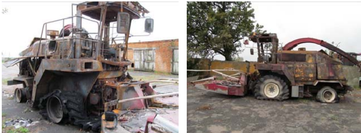
Рисунок 1 – Общий вид термических повреждений комбайна «КВК-800»
