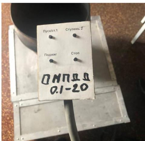
Рисунок 2. – Проводной пульт контроля
