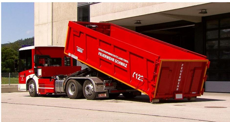
Рисунок 1. – Металлический контейнер с водой для погружения электромобиля после возгорания
