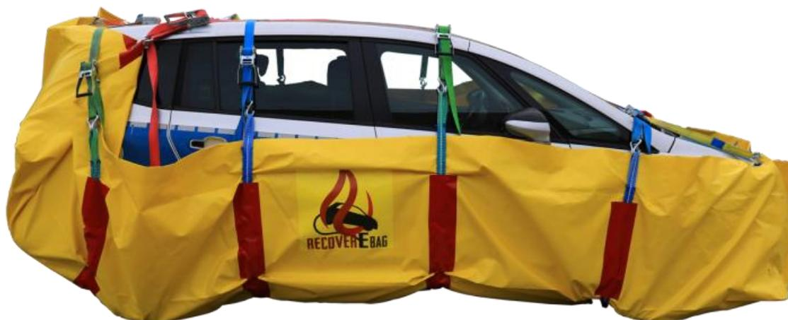
Рисунок 2. – Транспортный чехол для эвакуации электромобиля после возгорания, заполняемый водой
