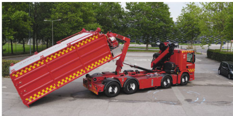
Рисунок 1 - Контейнеровоз для тушения электромобилей
