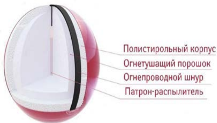
Рисунок 1. - Устройство АУПП
