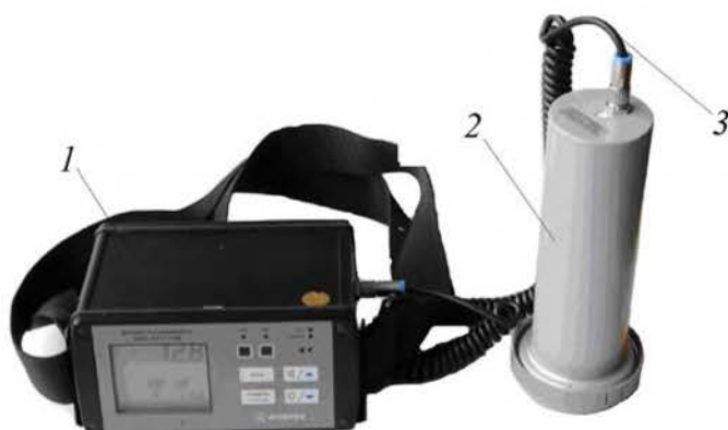
Рис. 3. – Дозиметр-радиометр МКС-АТ1117М: 1 – блок обработки информации (БОИ); 2 – блок детектирования БДПБ-01; 3 – соединительный кабель
