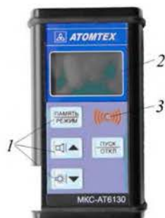
Рис. 2. Общий вид дозиметра-радиометра МКС-АТ6130: 1 – мембранная панель управления; 2 – жидкокристаллический индикатор (ЖКИ); 3 – светодиодный индикатор
