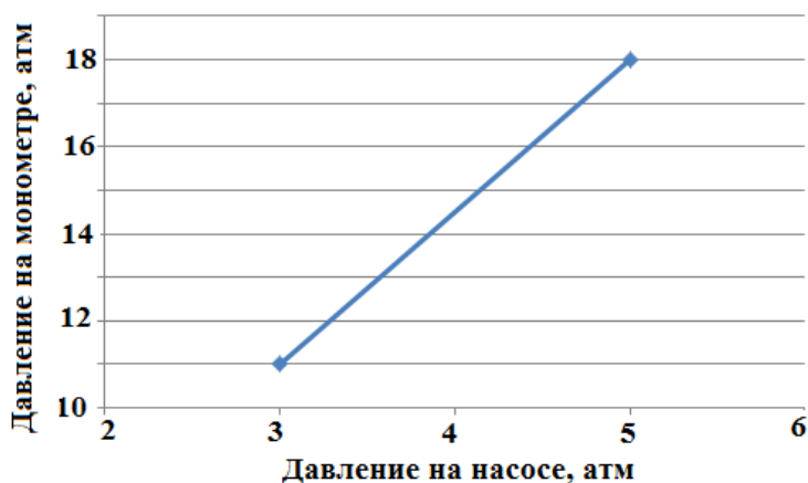
Рисунок – 3. Зависимость увеличения давления в рукавной линии при наезде на нее автомобиля, движущегося со скоростью 30 км/ч, на расстоянии в 1 м от места наезда.
