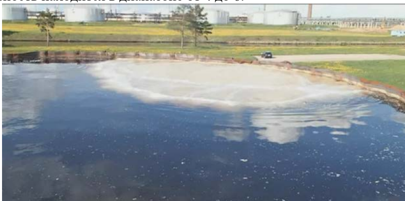
Рисунок – 3. Выход воздушно-механической пены на зеркало резервуара
