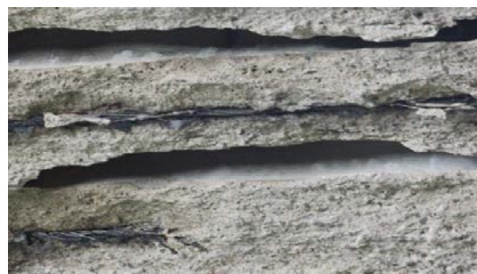
Рисунок –6. Разрушение защитного слоя бетона экспериментальных образцов
