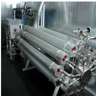
Рисунок – 1. Стационарная установка подачи азота
