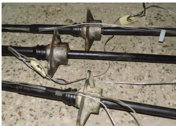
Рисунок –2. Канатная арматура с установленными термодатчиками и анкерами
