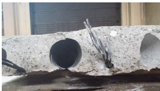
Рисунок –6. Разрушение защитного слоя бетона экспериментальных образцов
