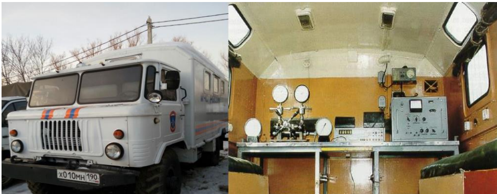
Рисунок – 3. Подвижный контрольно-измерительный пункт КИП-У1
