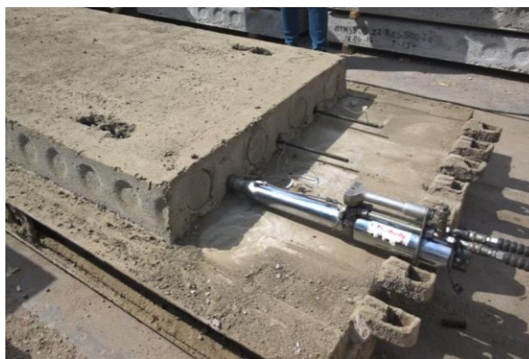
Рисунок –3. Преднапряжение канатной арматуры экспериментальных плит
