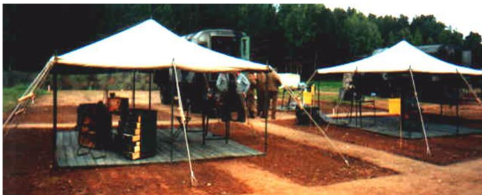
Рисунок – 4. Передвижная ремонтно-химическая мастерская ПРХМ-1М в развёрнутом виде
