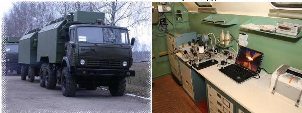
Рисунок – 2. Подвижная лаборатория измерительной техники ПЛИТ-АЗ-2
