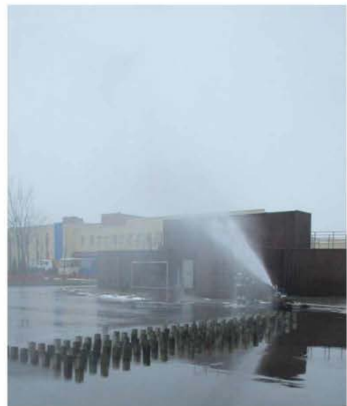
Рисунок 4.5 – Определение эффективной дальности распыленной струи ствола СПРУК 50/0,7 «Викинг»
