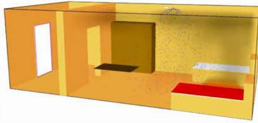
Рис. 2. Модель помещения с работающей системой пожаротушения
