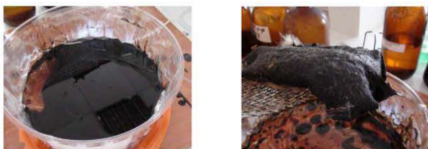
Рисунок 2. – Извлечение насыщенной нефтью порции пуха початков рогоза
