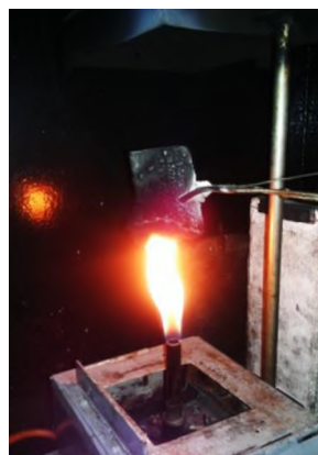
Рисунок 1 – Общий вид экспериментальных исследований по ГОСТ 16363
