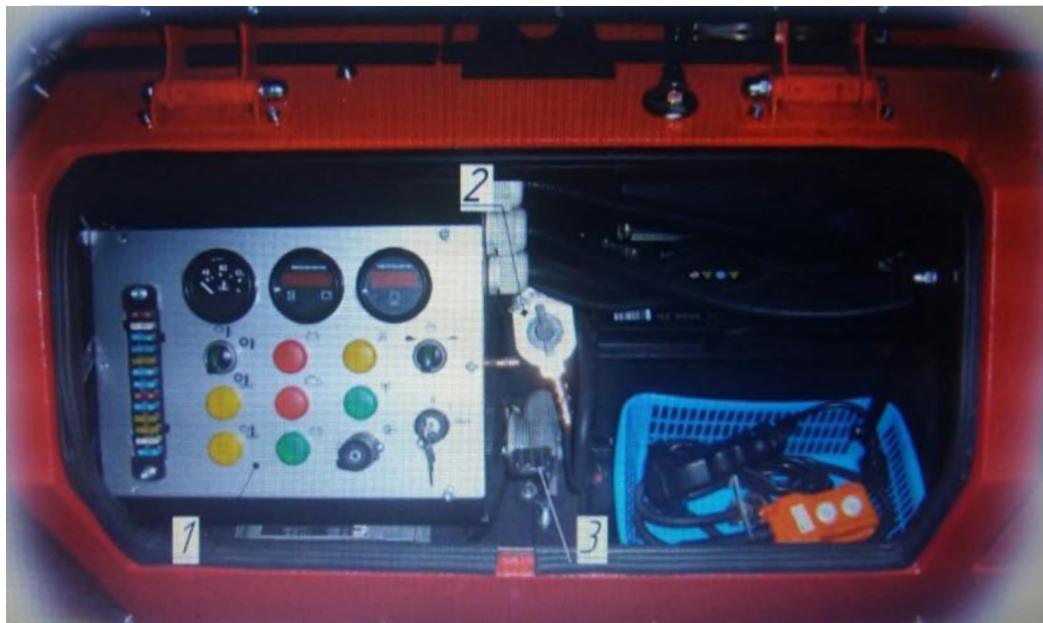
Рисунок 2 – Размещение элементов управления: 1 – пульт пуска и контроля за работой двигателя; выключатель «массы»; 3 – рычаг ручного управления подаче топлива
