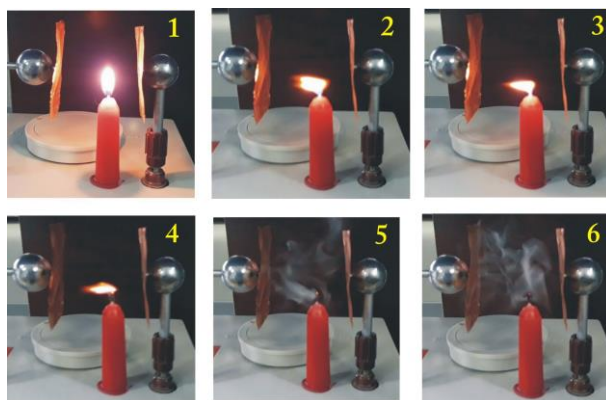
Рисунок 2 – Последовательные фазы процесса по тушению пламени с помощью электрического поля
