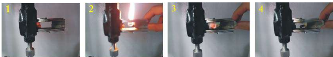
Рисунок 4 – Тушение пламени с помощью постоянного магнитного поля: 1 – набор неодимовых магнитов; 2-4 – последовательные фазы процесса тушения
