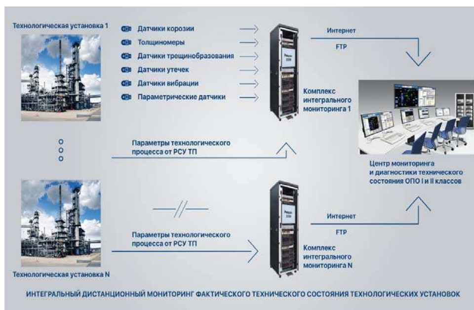
Рисунок 1. – Система мониторинга опасных производственных объектов
