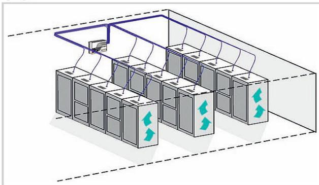
АДПИ классифицируются по чувствительности и могут быть отнесены к одному из 3-х классов (Fire Detection and Fire Alarm Systems. Aspirating Smoke Detectors, EN-54-20, 2006):
