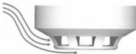
**Рисунок 3 – Типовой корпус извещателя**
