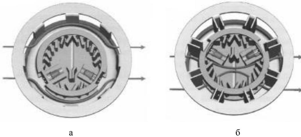
**Рисунок 2 – Схема вентилируемости извещателя: а – некорректная; б – корректная**
