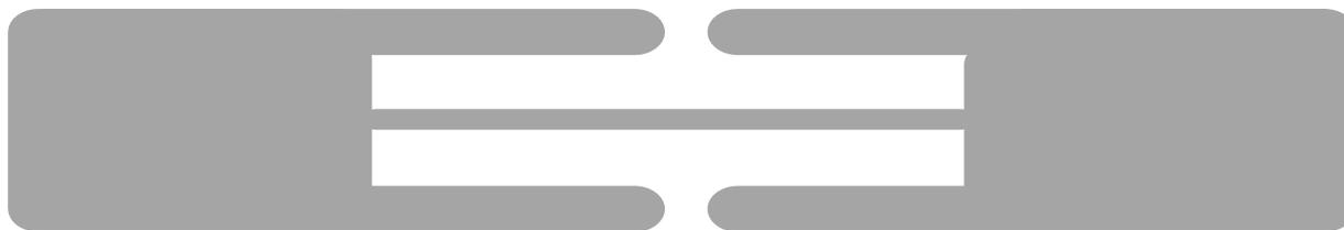
Рисунок 3 – ЭА со встроенной нагрузкой на компланарной линии передачи
