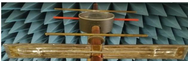
Рисунок 5 – 4-элементная ДА со встроенной нагрузкой ЭА на компланарной линии передачи, принадлежащего антенне смежного диапазона
