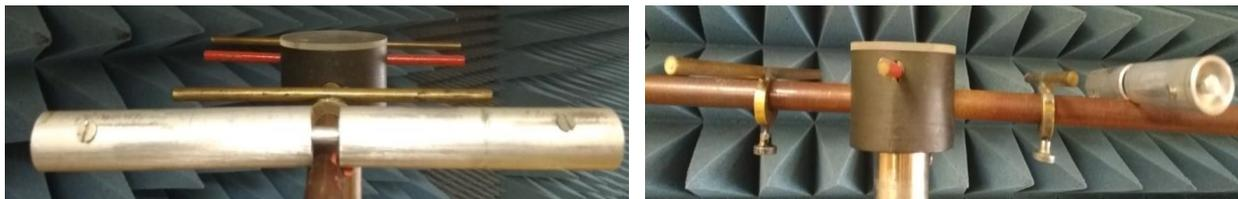
Рисунок 4. – 4-элементная ДА со встроенной коаксиальной нагрузкой ЭА, принадлежащего антенне смежного диапазона
