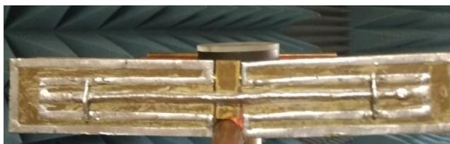
Рисунок 6 – Вибратор со встроенной нагрузкой ЭА на компланарной линии передачи
