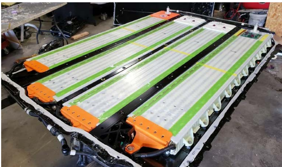
Рисунок 2. – Конструкция аккумуляторного блока LFP АКБ EV Tesla Model 3
