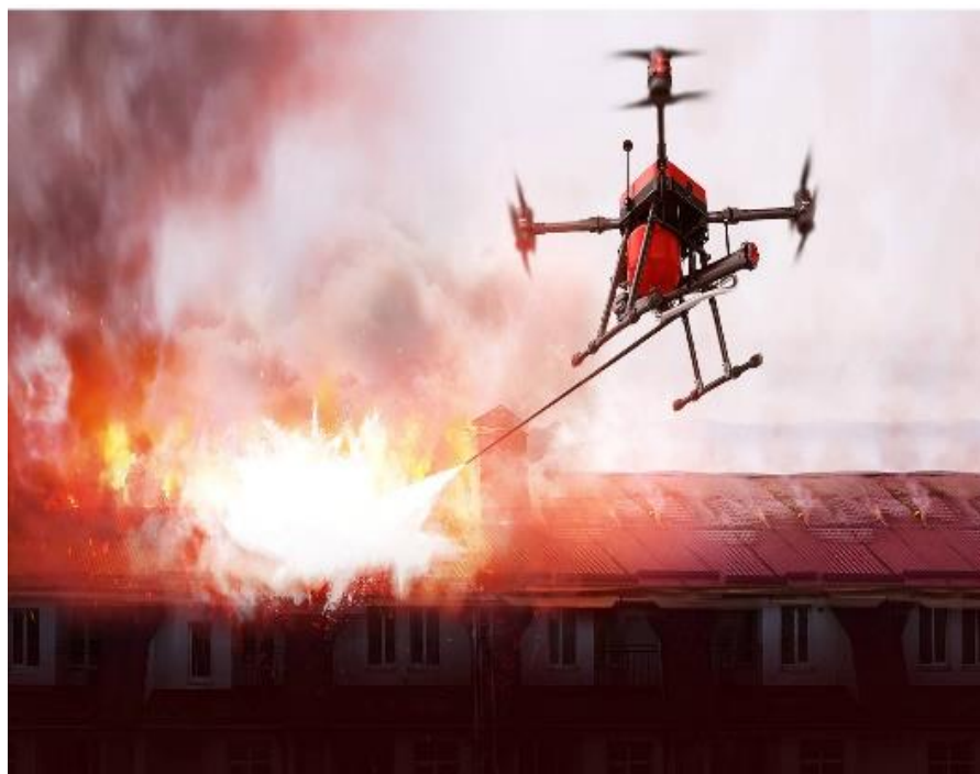
Рисунок 4. Тушения пожара беспилотным летательным аппаратом
