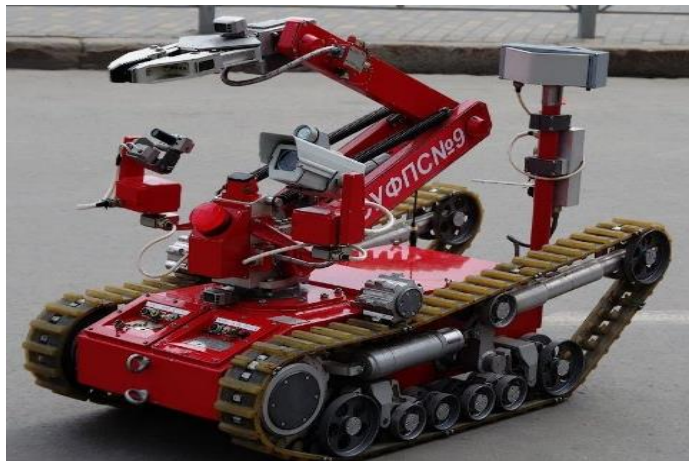
Рисунок 1. - Мобильный робототехнический комплекс МРК-27Х
