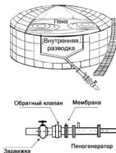
Рисунок 1. – Принцип организации процесса подслойного тушения резервуара
