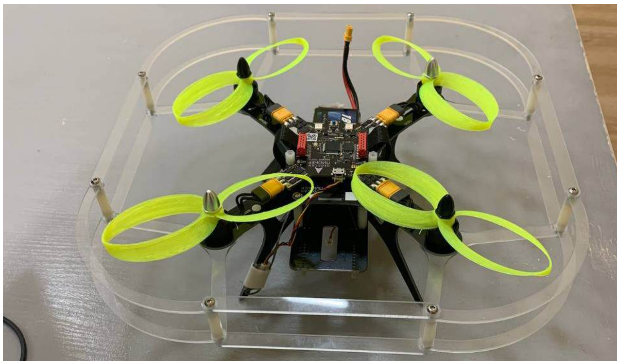
Рисунок 3. – Испытание спроектированного винта на базе электродвигателя MT1306 KV3100
