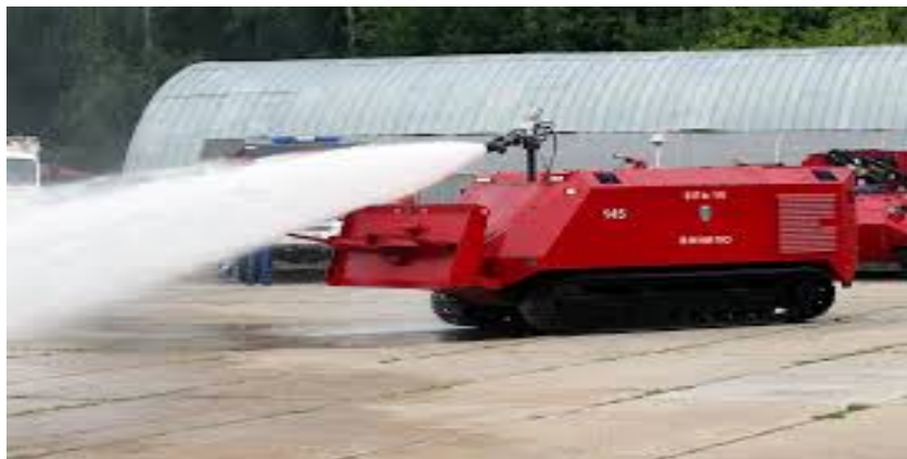
Рисунок 2. - Пожарный робот тяжелого класса Ель-10
