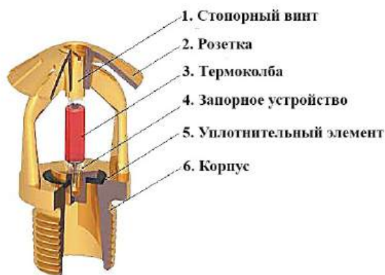
Рисунок 2. – Спринклерный ороситель с термоколбой
