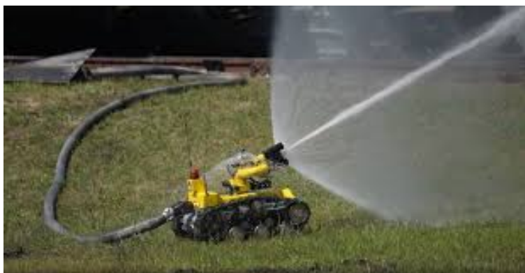
Рисунок 4. – Пожарный робот CITIC RXR M40D
