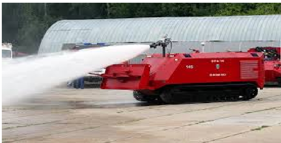
Рисунок 1. - Противопожарный роботизированный комплекс для работы в зоне повышенной опасности «Ель-10»
