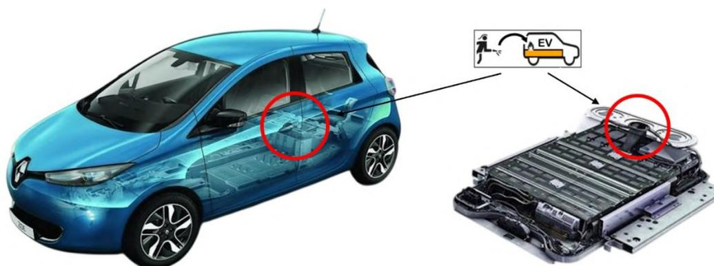
Рисунок 1 – Специальный порт в верхней части АКБ для подачи ОВ
