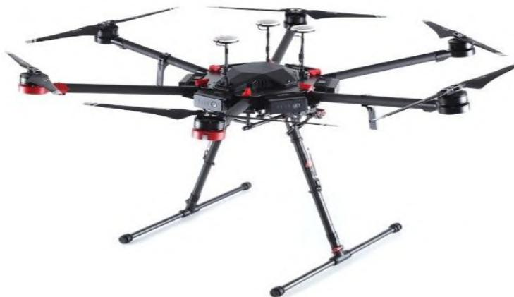
Рисунок 1 – Беспилотный летательный аппарат (гексакоптер) «DJI Matrice 600 Pro»
