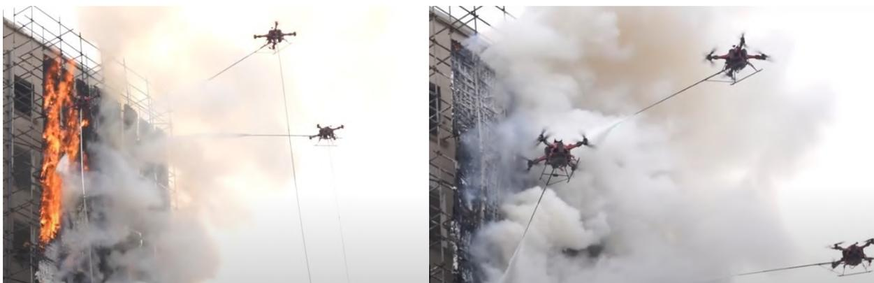
Рисунок 1 – Использование БПЛА при тушении пожаров на большой высоте
