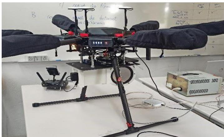
Рисунок 2 – Внедрение в беспилотный летательный аппарат (гексакоптер) «DJI Matrice 600 Pro» радиационного детектора
