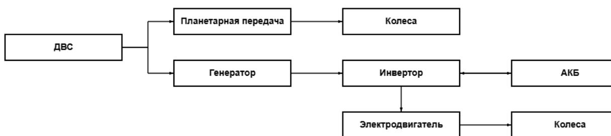
Рисунок 2 – Принцип работы HEV
