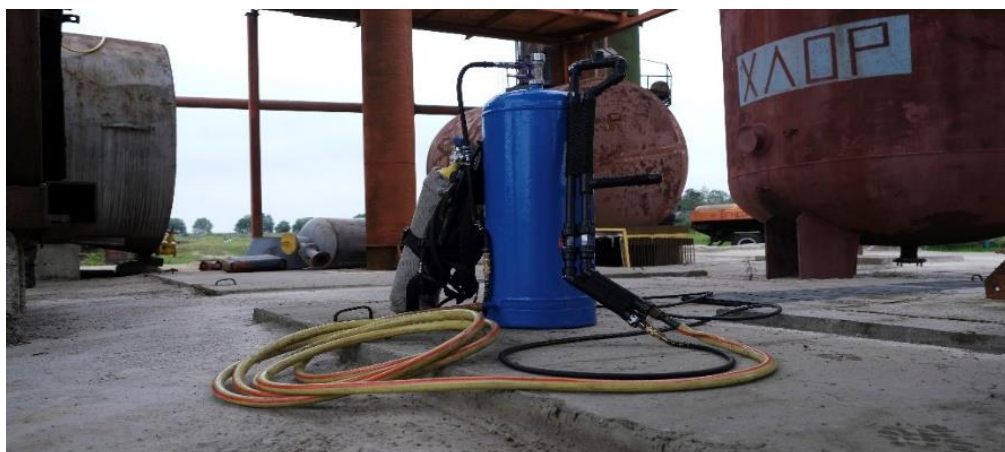
Рисунок 2 – Внешний вид установки пожаротушения со стволом гетерофазной подачи огнетушащих веществ
