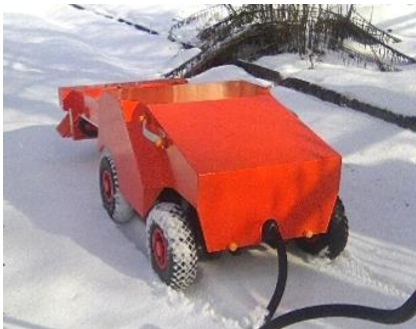
Рисунок 2 – Общий вид радиолокатора ближнего действия с непрерывным излучением для подповерхностного зондирования малоуглубленных объектов
