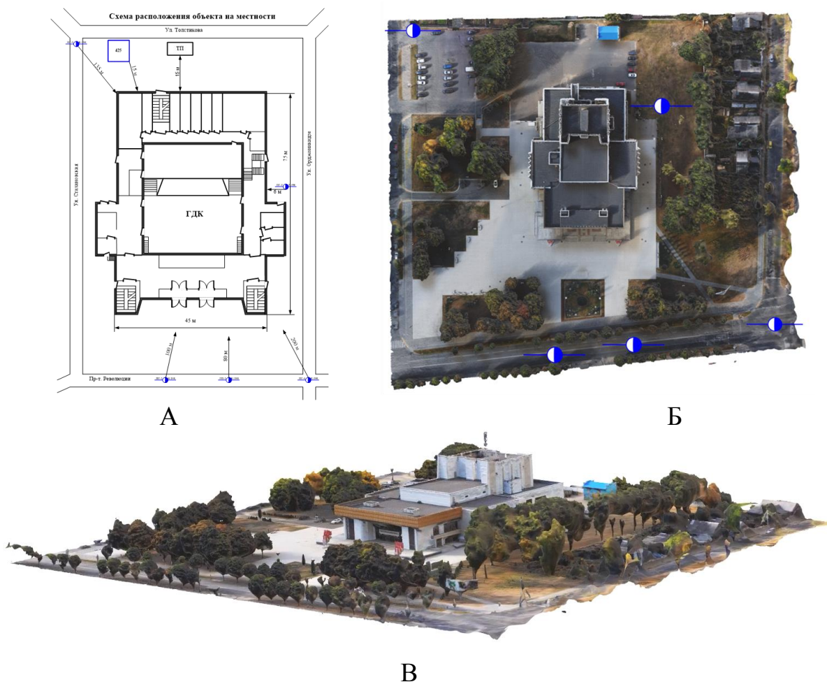
Рисунок 1 – Схема на местности объекта оперативного плана (А) и пример 3D модели объекта на местности (Б, В)
