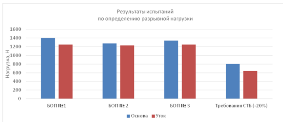
Рисунок 3 – Результаты испытаний по определению разрывной нагрузки
