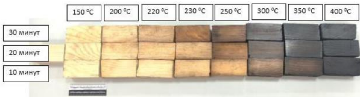
Рисунок 1 – Вид образцов древесины после термического воздействия [2]
