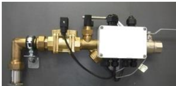
Рисунок 5 – Система подготовки и подачи воды в форсунки
