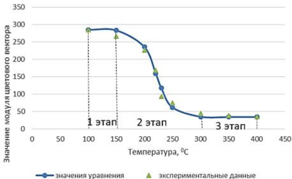
Рисунок 3 – Физическая модель изменения значений модуля цветового вектора от температуры для образцов древесины [2]
