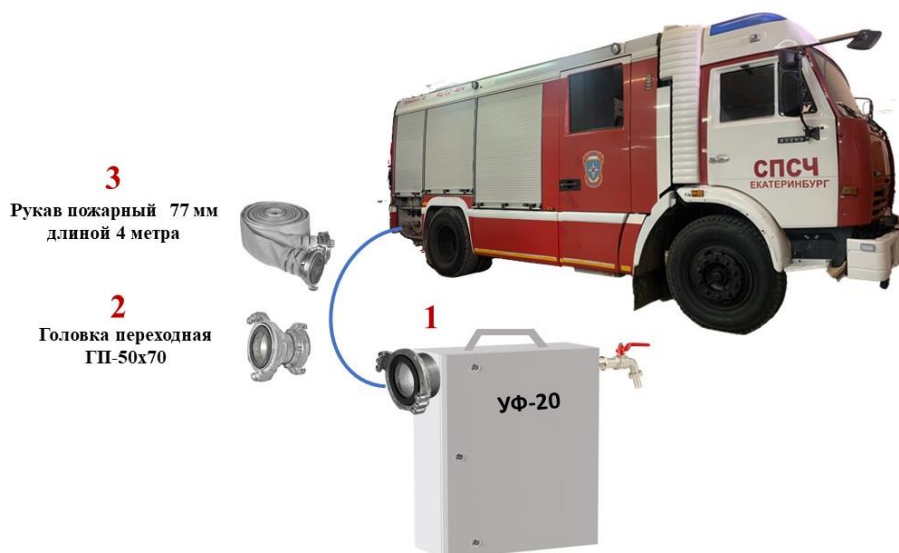
Рисунок 2 – Принцип подключения устройства фильтрации
