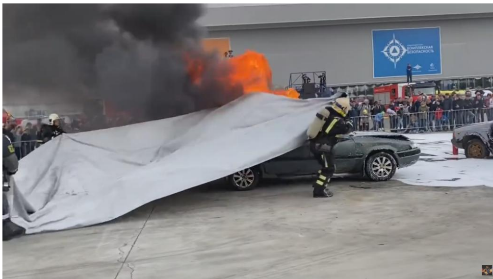
Рисунок 1 – Применение противопожарного полотна при ликвидации возгорания легкового автомобиля
