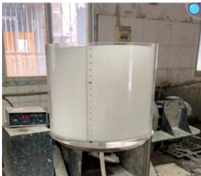
Рисунок 1 - Прибор для измерения расстояния осаждения и скорости выделения пены в течение 1 часа
