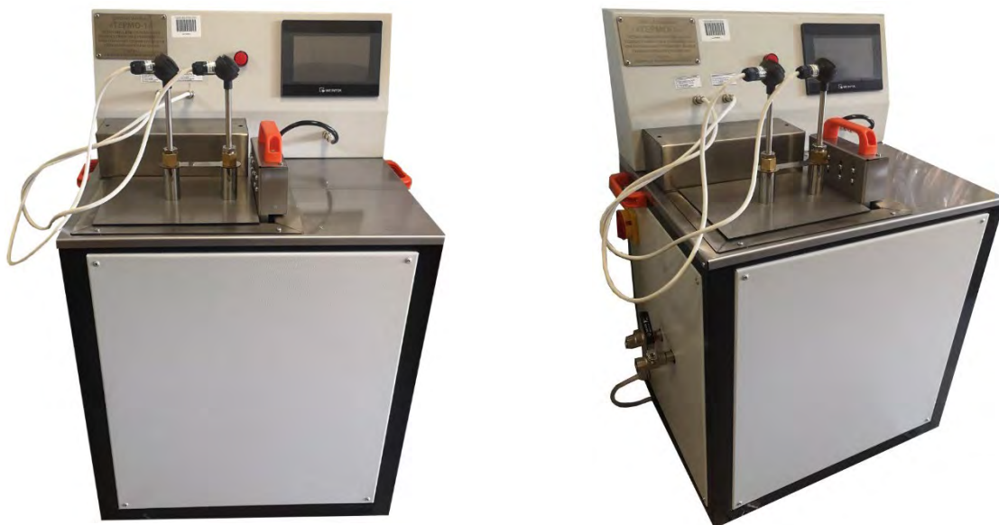
Рисунок 3. – Внешний вид установки для определения теплостойкости и температуры срабатывания теплового замка спринклерного оросителя
