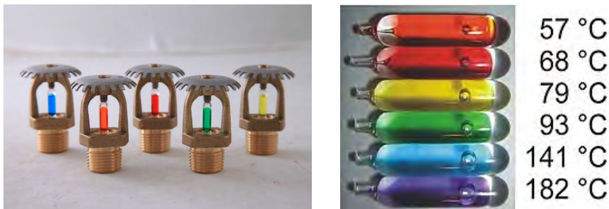
Рисунок 3. – Спринклерные оросители с различной номинальной температурой срабатывания
