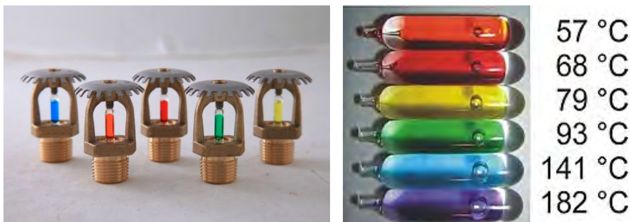
Рисунок 1. – Спринклерные оросители с различной номинальной температурой срабатывания
