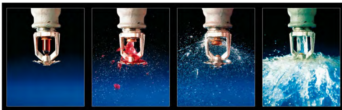
Рисунок 2. – Срабатывание спринклерного оросителя с разрывным термочувствительным элементом (термоколбой)
