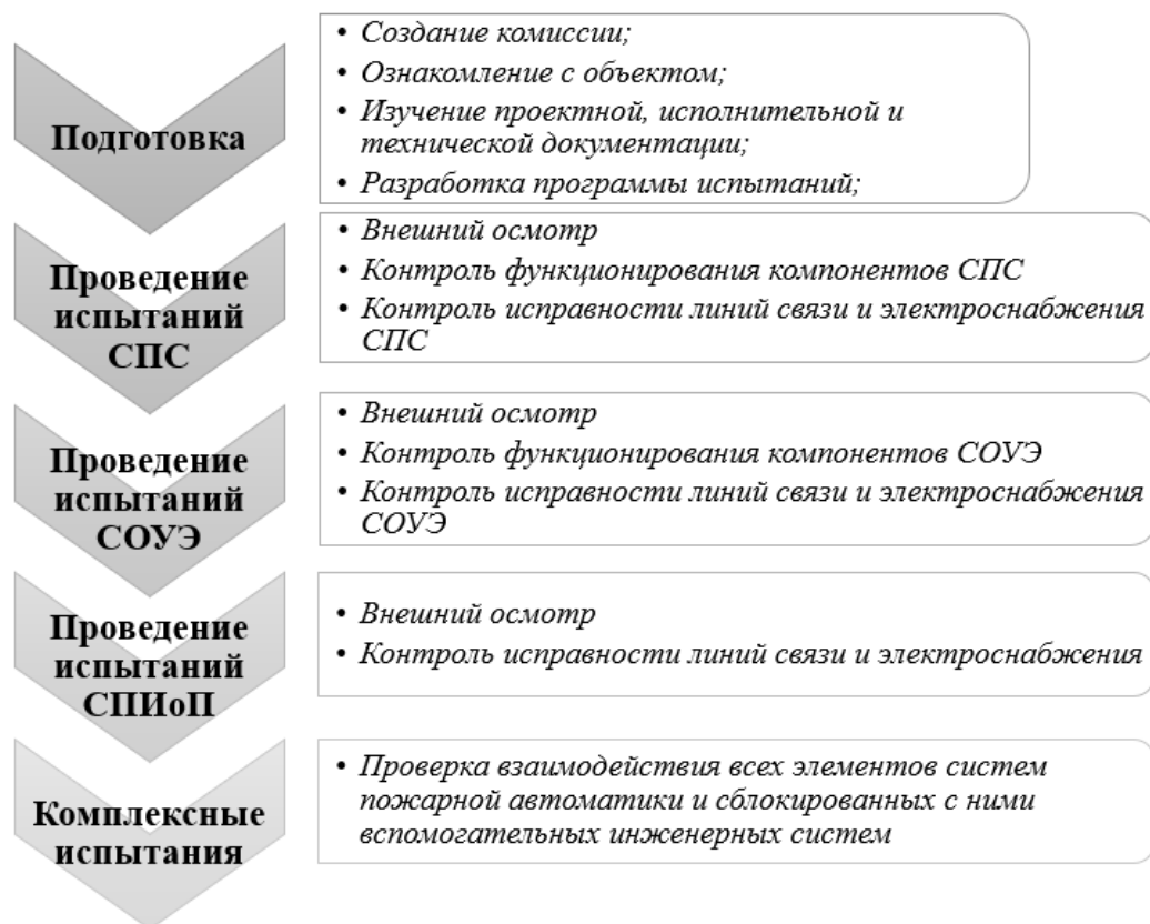
Рисунок 3. – Алгоритм проведения испытаний по проверке работоспособности СПС, СОУЭ, СПИюП
