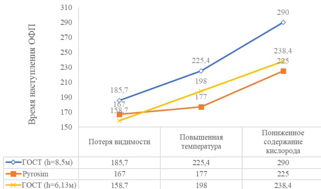
Рис.2. Сравнение времени наступления критических значений ОФП на примере ангара с пожарной нагрузкой древесины и фанера.
