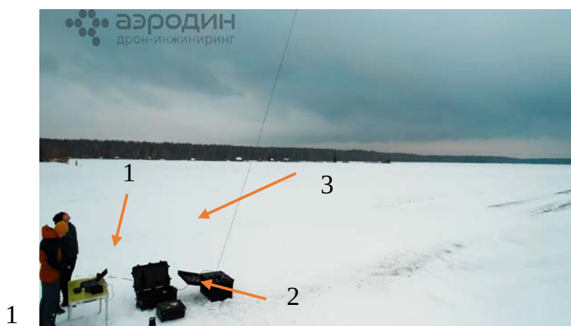
Рисунок 2 – БЛА (дрон) на привязи «Центурион»: 1 – элемент питания БЛА; 2 – блок управления с катушкой; 3 – кабель с кевларовой нитью
