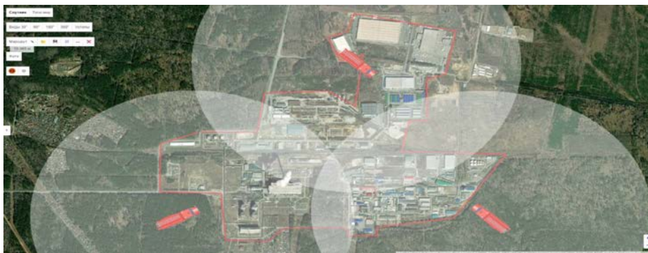
Рисунок 4 – Зона покрытия системой подавления
