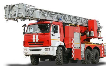
АЛ-32 на базе шасси КамАЗ 43118
