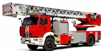
АЛ-32 на базе шасси КАМАЗ 53605
