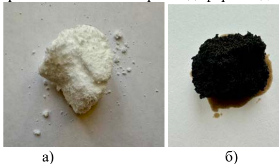
Рисунок 1 – а полимерный сорбент; б сорбент с поглощенным нефтепродуктом
