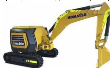
Рис. 2 – Беспилотный электрический мини-экскаватор Komatsu
