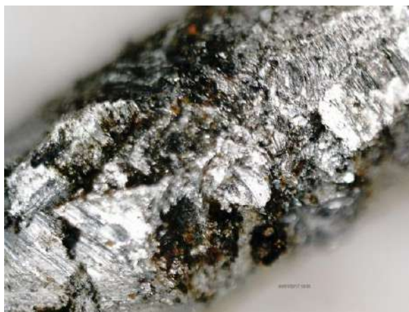
Рисунок 2. – Вкраплениями меди на поверхности жилы алюминиевого провода в месте контактного соединения «в скрутку» при увеличении
