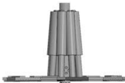
Рисунок 2. – Грузозахват в раскрытом состоянии является подъемным устройством
