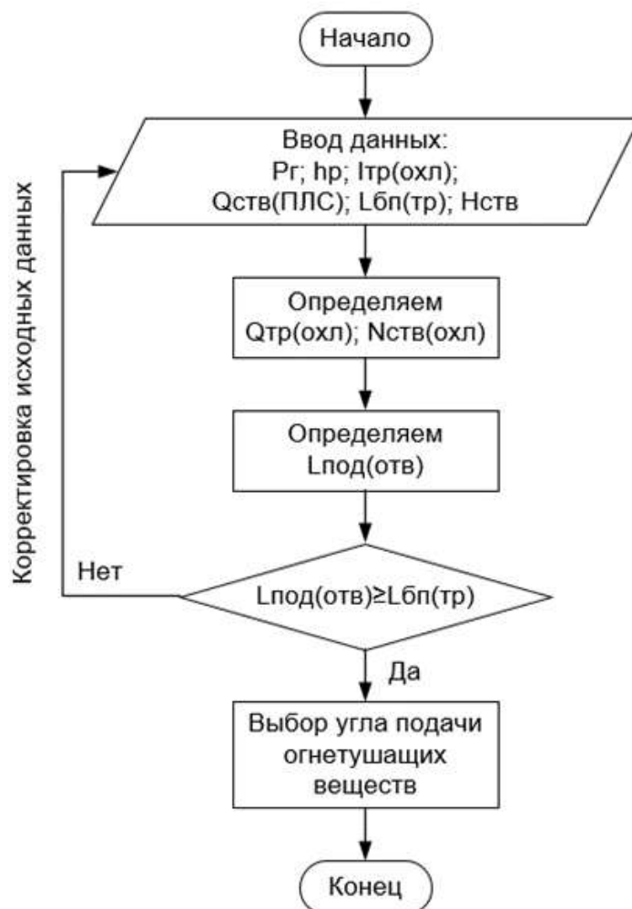
Рисунок. – Алгоритм определения боевой позиции лафетного ствола при тушении вертикального стального резервуара
