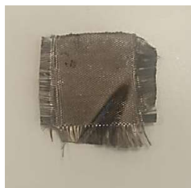
Рисунок. – Фотографии поверхности силикатной ткани с автокаталитическим покрытием Ni-P толщиной 8 мкм; образца после огневых испытаний
