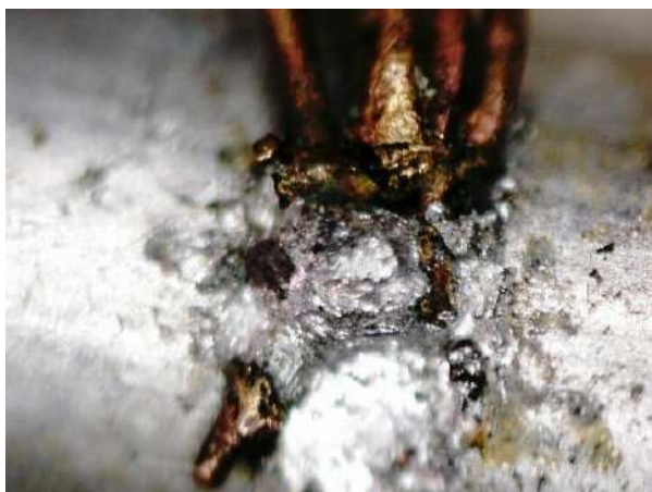
Рисунок 1. – Сплавление поверхностей жил медного и алюминиевого проводов в месте контактного соединения «в скрутку» при увеличении
