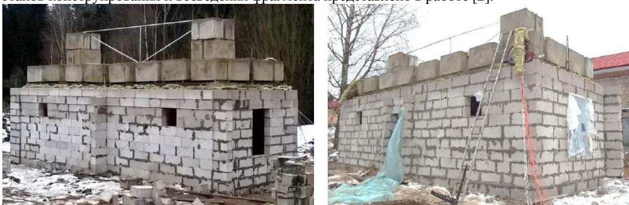
Рисунок – Общий вид испытательного фрагмента каркасного здания
