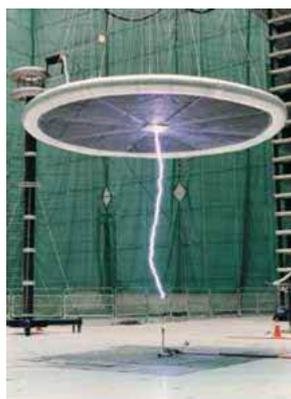
Рисунок 3 – Испытание активного молниепремника
