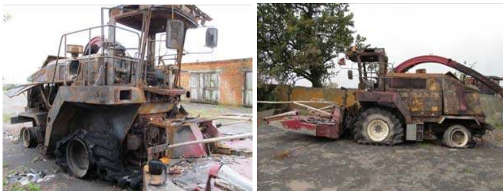
Рисунок 1. – Общий вид термических повреждений комбайна «КВК-800»
