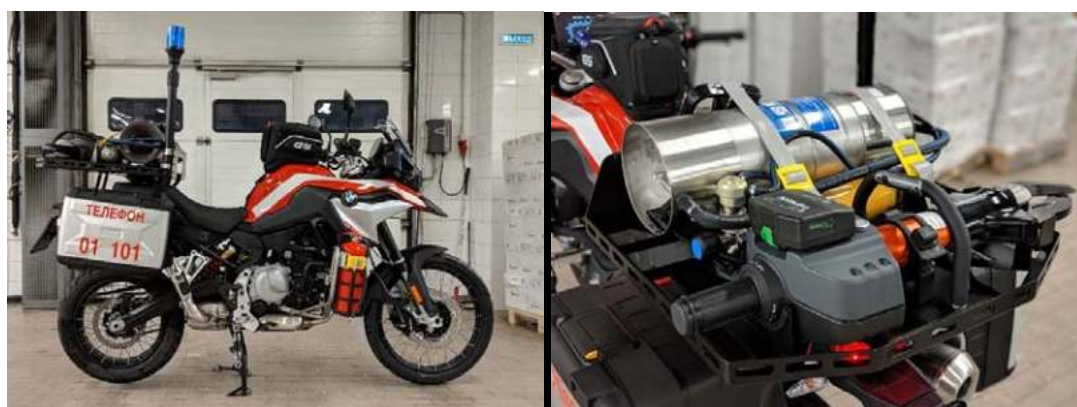
Рисунок 2 – Пожарно-спасательный мотоцикл на шасси BMW 1200 GS
