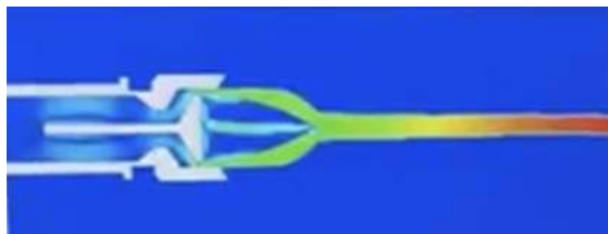
Рисунок 1 – Визуализация численного моделирования течения жидкости из универсального насадка
