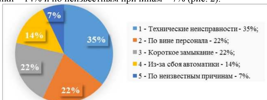
Рис. 2. Основные причины возникновения аварийных ситуаций на АЭС
