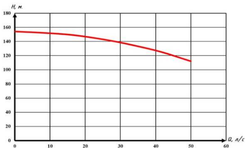
Рисунок 1 – График зависимости напора от подачи насоса насос Rosenbauer NH30
