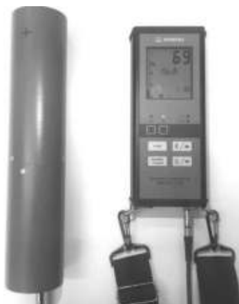
Рис. 1. Вид дозиметра-радиометра МКС-АТ1117М с внешним блоком детектирования БДКГ-05
