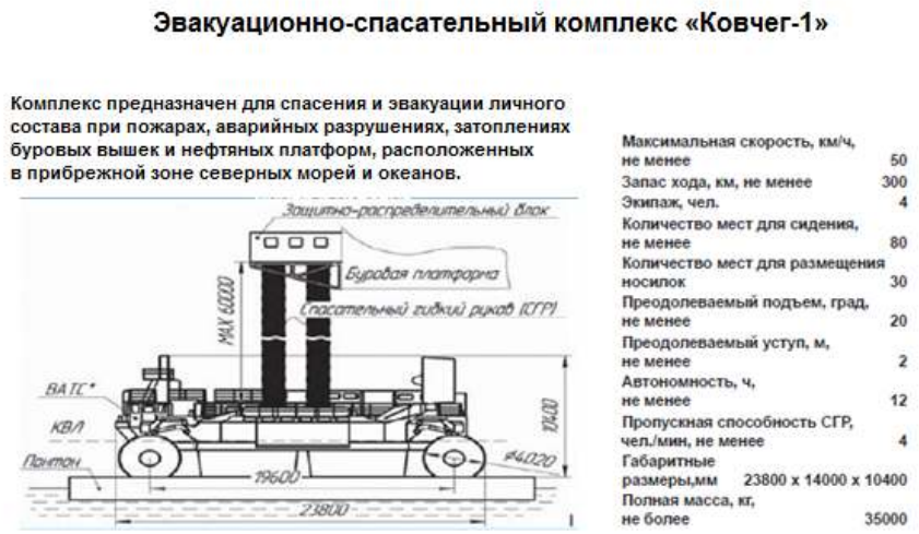
Рис. 3. Эвакуационно-спасательный комплекс «Ковчег-1» (ВАТС — высокоманевренное автономное транспортное средство)
