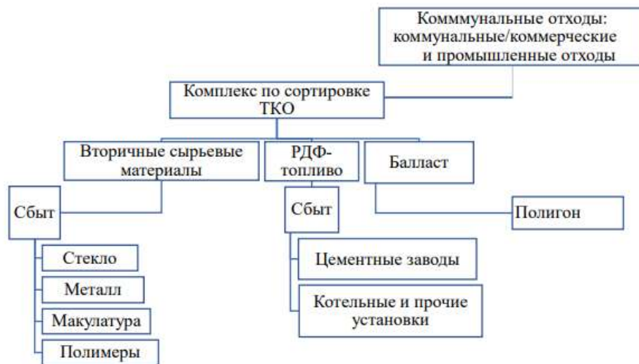
Рисунок 2. Увеличенная схема получения RDF-топлива [4]
