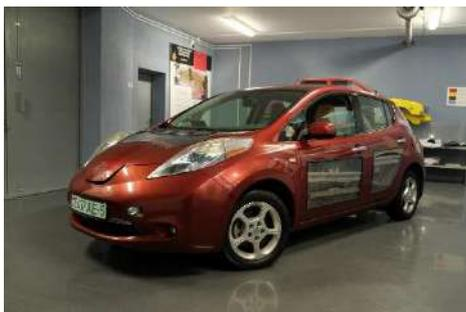
Рисунок 1. – Внешний вид массо-габаритной модели электромобиля на базе шасси Nissan Leaf первого поколения
