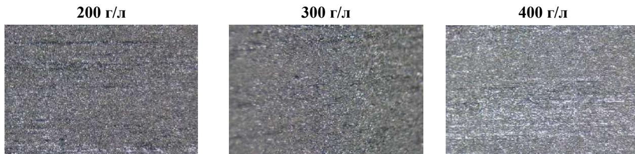
**Рисунок 3 – Фотографии поверхности никелевых покрытий, полученных из кремнефтористых электролитов при различных концентрациях Ni[SiF<sub>6</sub>] в электролите (температура раствора – 50 °С) и плотности тока 10 А/дм<sup>2</sup>**
