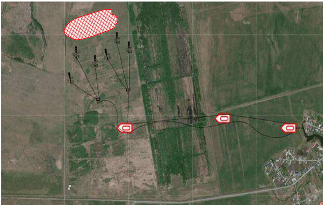
Рисунок 1. Схема организации перекачки воды из насоса в насос от водоисточника к месту торфяного пожара
