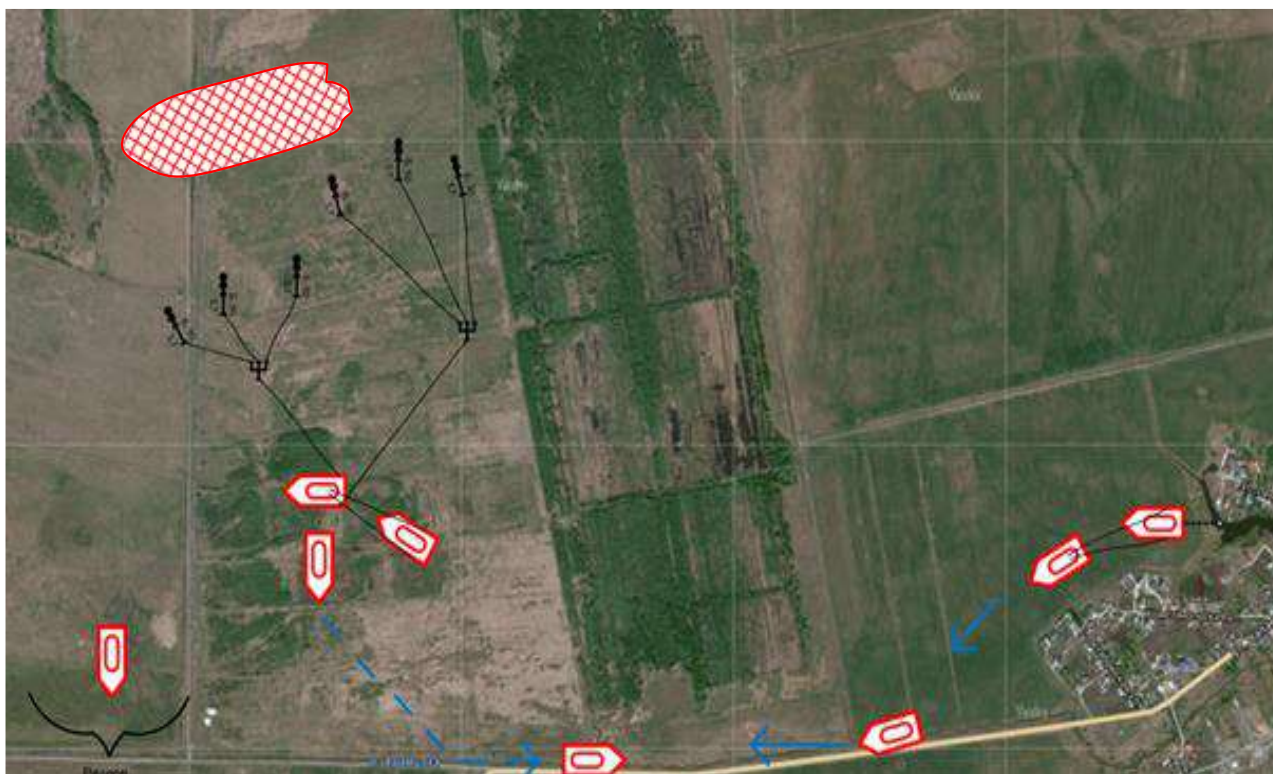
Рисунок 2. Схема организации подвоза воды к торфяному пожару
