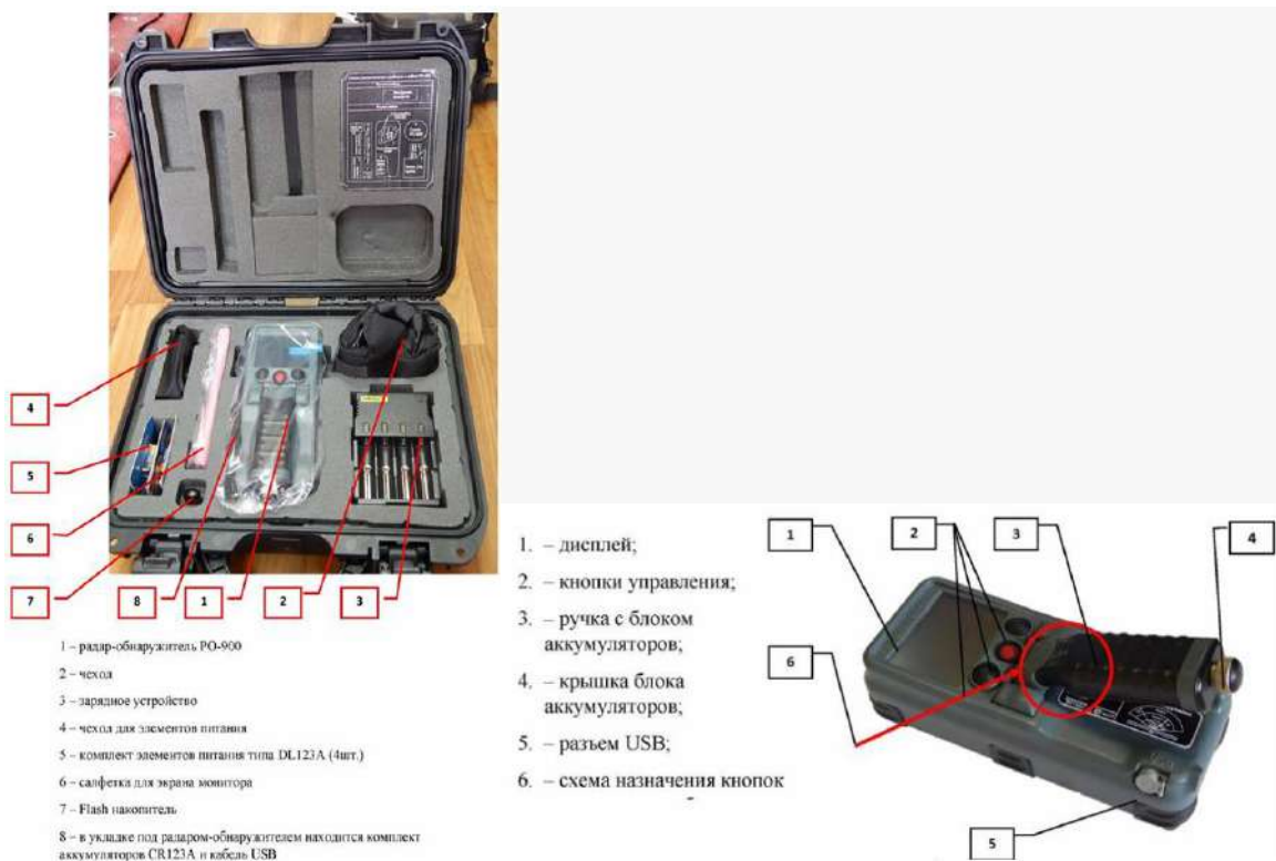
Рисунок 4. Устройство и комплектация стеновизора РО-900 [8]
