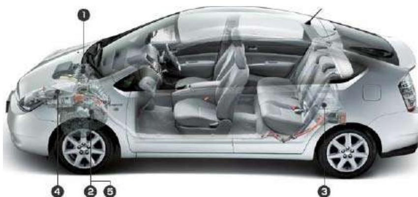
**Рисунок 1. Высоковольтная система гибридного автомобиля Toyota Prius:
