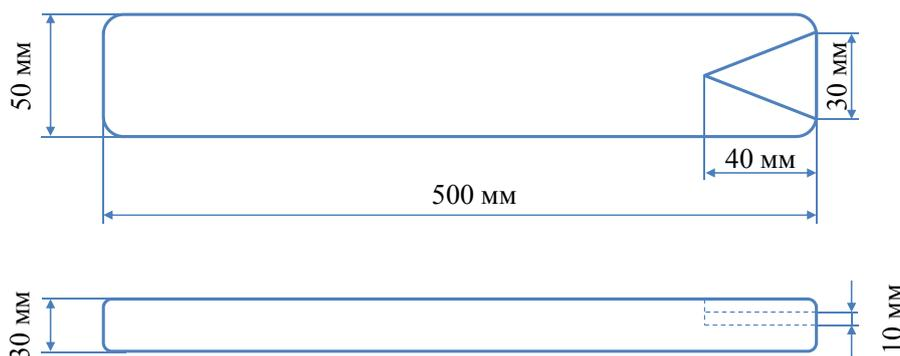
**Рисунок 3 – Разработанное устройство – пожарный челнок**
