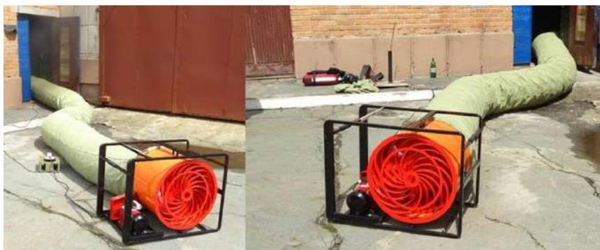
**Рисунок 1. – Дымосос переносной с электроприводом**
