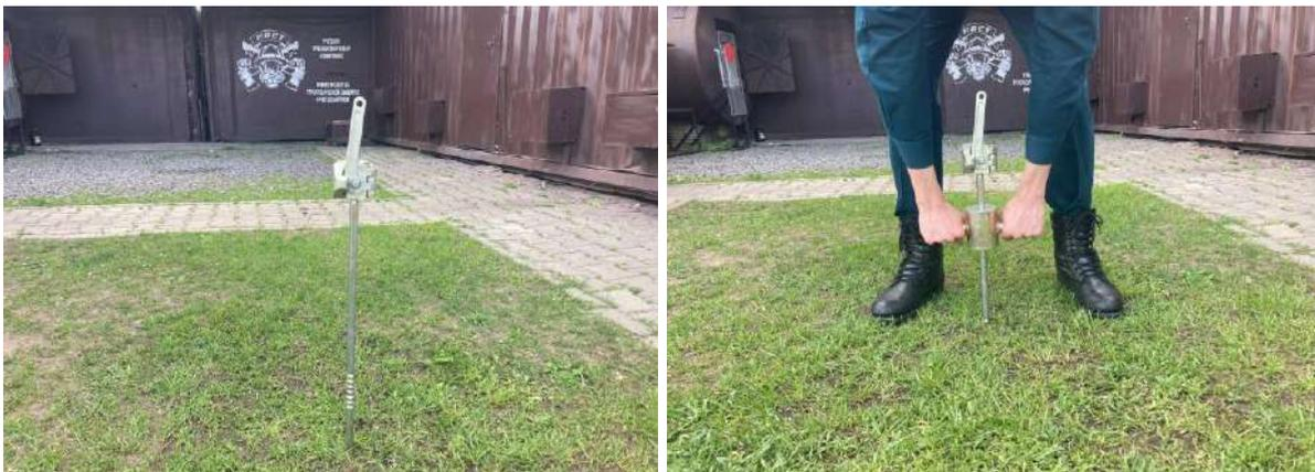
**Рисунок 5. – Техника извлечения заземляющего штыря из грунта**
