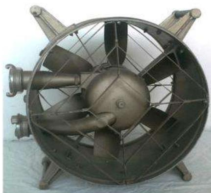
**Рисунок 3. – Дымосос переносной с гидроприводный**
