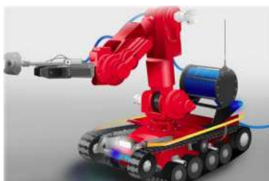
Рис. 2. Робототехническое средство, оснащенное роботизированной рукой-манипулятором со схватом, имеющая пять степеней свободы, ствол установки пожаротушения с гидроабразивной резкой, предназначенный для тушения пожаров и резки конструкций, система технического зрения, тепловизор и набор необходимого оборудования
