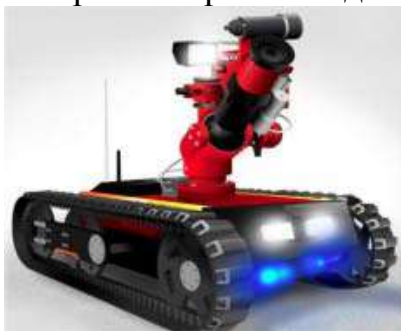
Рис. 1. Робототехническое средство, предназначенное для разведки на месте пожара, мониторинга обстановки и выполнения действий по тушению пожаров
