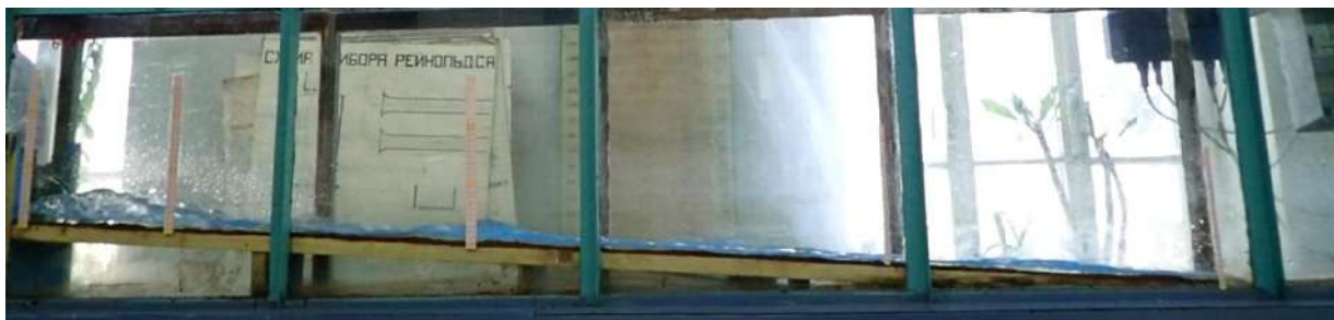
Рис. 4 – Общий вид волны перемещения при мгновенном открытии затвора
