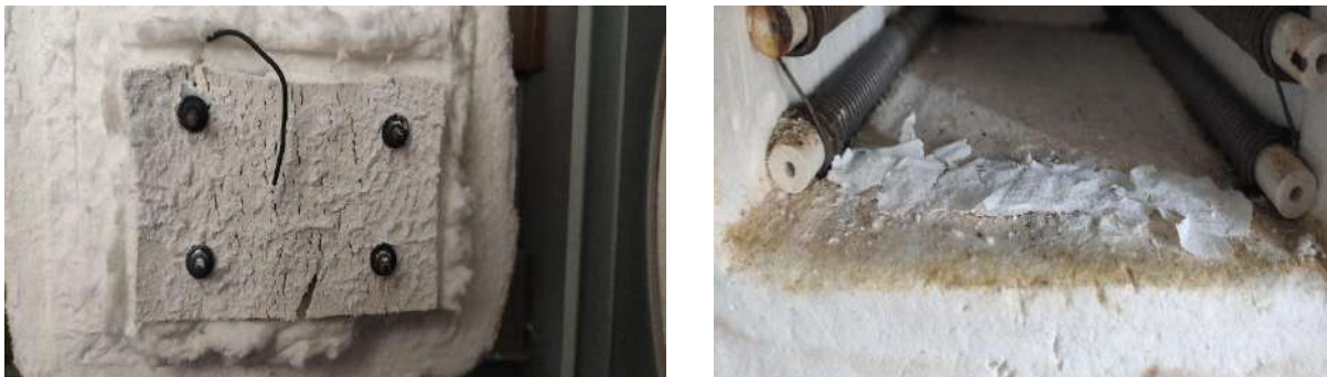
Рис. 2. Вид образца гипсовой плиты Gyproc Fire (ПНГФ), толщиной 12,5 мм, после проведения испытаний
