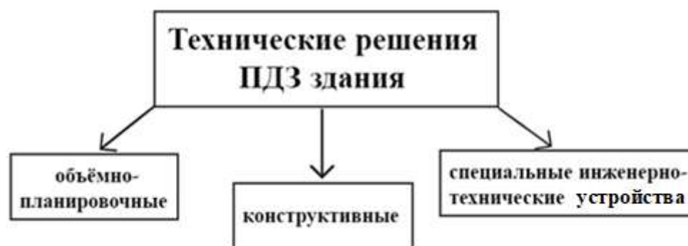
Рис. 1. – Технические решения противодымной защиты здания
