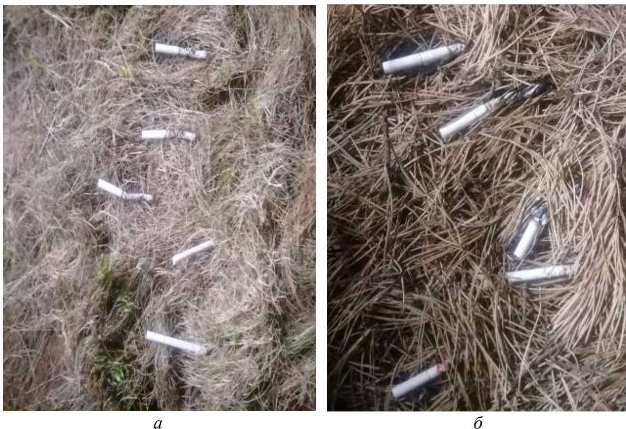
Рисунок 1. – Процесс воздействия тлеющих сигарет на образец травы (а) и сосновой хвои (б)
