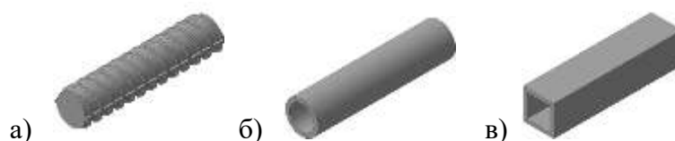
Рисунок 2. – Образцы разрушаемого материала: а) арматура; б) круглая труба; в) квадратная труба
