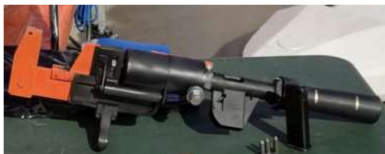
Рисунок 6. – Действующий опытный макет аварийно-спасательного инструмента с пиропроводом
