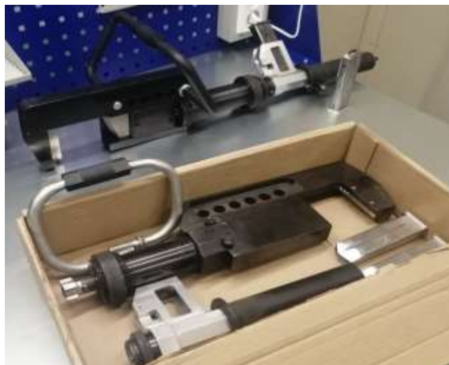
Рисунок 7. – Модель опытного образца аварийно-спасательного инструмента с пиропроводом
