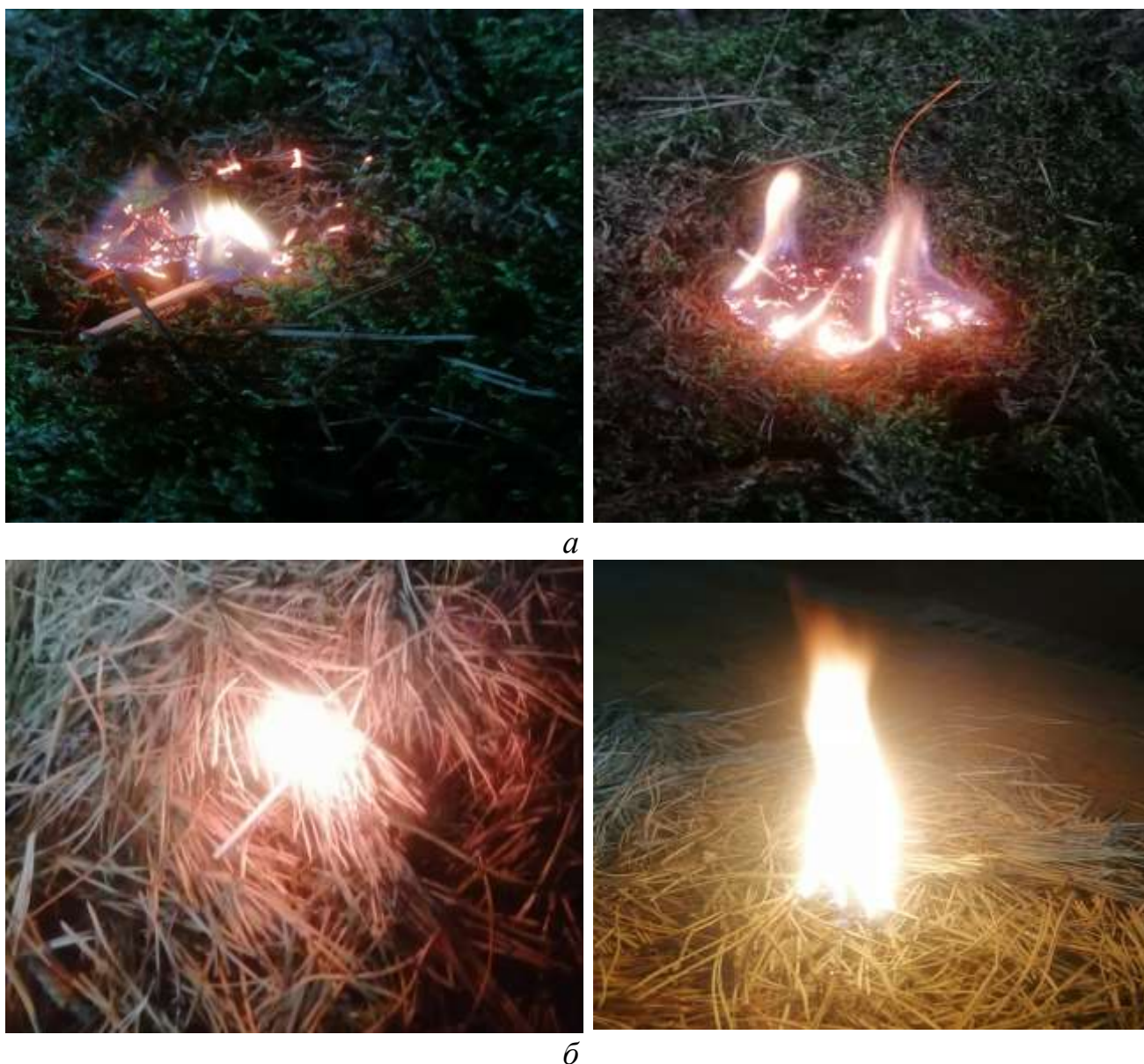
Рисунок 1. – Процесс воспламенения образца мха ( а ) и сосновой хвои ( б ) от брошенной горячей спички
