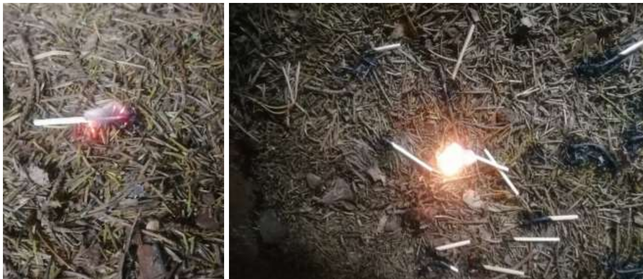
Рисунок 2. – Процесс воздействия горящей спички на образец еловой хвои без возникновения устойчивого пламенного горения
