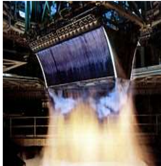
Рисунок 2. – Турбулентное пламя мощного клиновидного ракетного двигателя для многоразового одноступенчатого аэрокосмического корабля Lockheed Martin X-33
