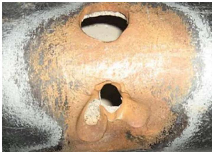
**Рис.1** – Воздействие блуждающих токов на трубопровод
