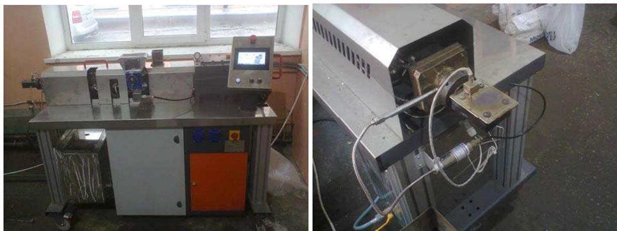
**Рисунок 1 – Двухшнековый экструдер «Suplast 25/2» с формующей оснасткой**
