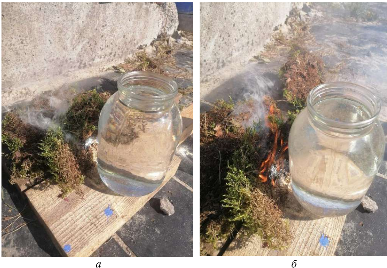
Рисунок 1 – Воспламенение мха при воздействии сфокусированного солнечного излучения ( а – процесс активного выделения газообразных продуктов пиролиза, б – процесс воспламенения)
