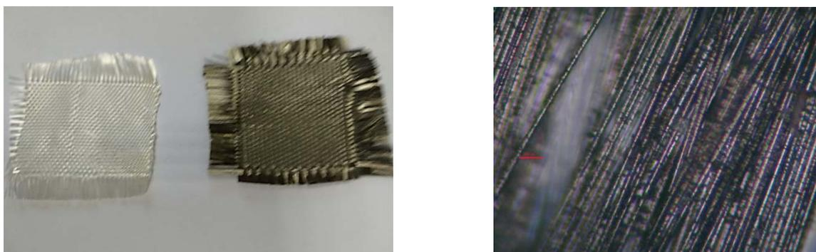
Рисунок – Фотографии исходной стеклоткани и с покрытием Ni-P толщиной 12 мкм
