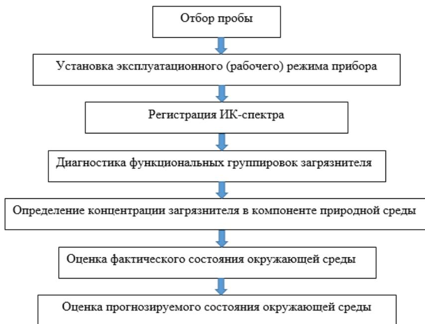
**Рисунок 1** Блок-схема методики экологического мониторинга методом ИК-спектроскопии
