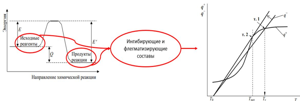
Рисунок 1 – Энергетическая взаимосвязь химической реакции и тепловой теории потухания
