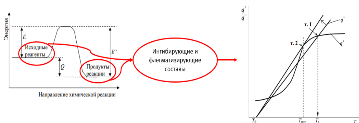
Рисунок 1. – Энергетическая взаимосвязь химической реакции и тепловой теории потухания
