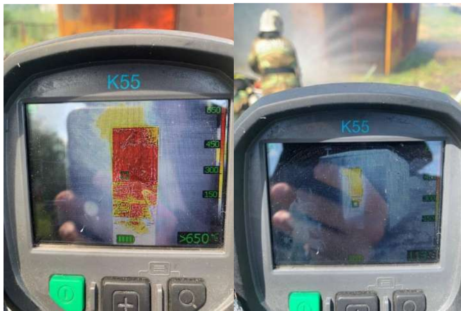
Рисунок 2 – Показания тепловизора «Flir K 55» в начале и в конце эксперимента
