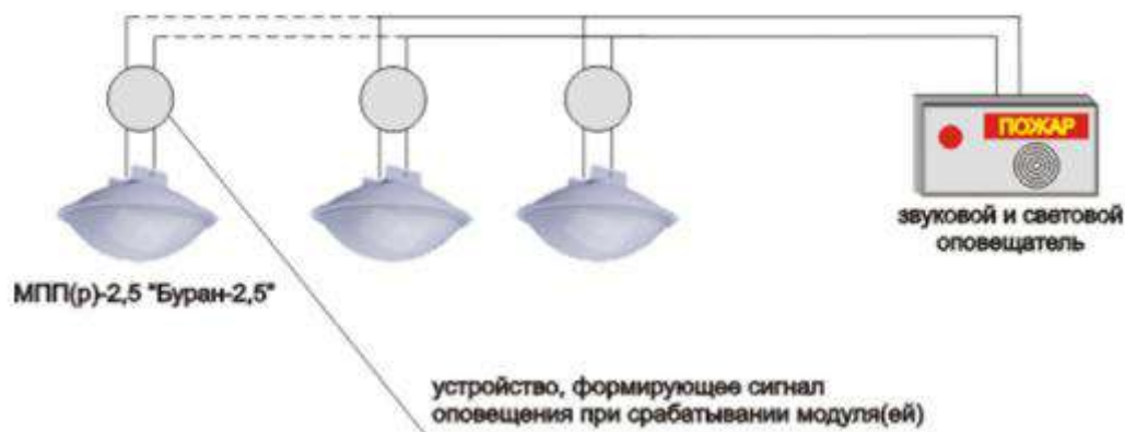
Рисунок 4 – Вариант подключения модуля с детектором пламени
