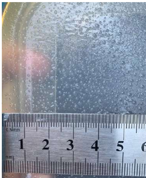
Рисунок 4 – Размеры и вид капель мелкодисперсной воды
