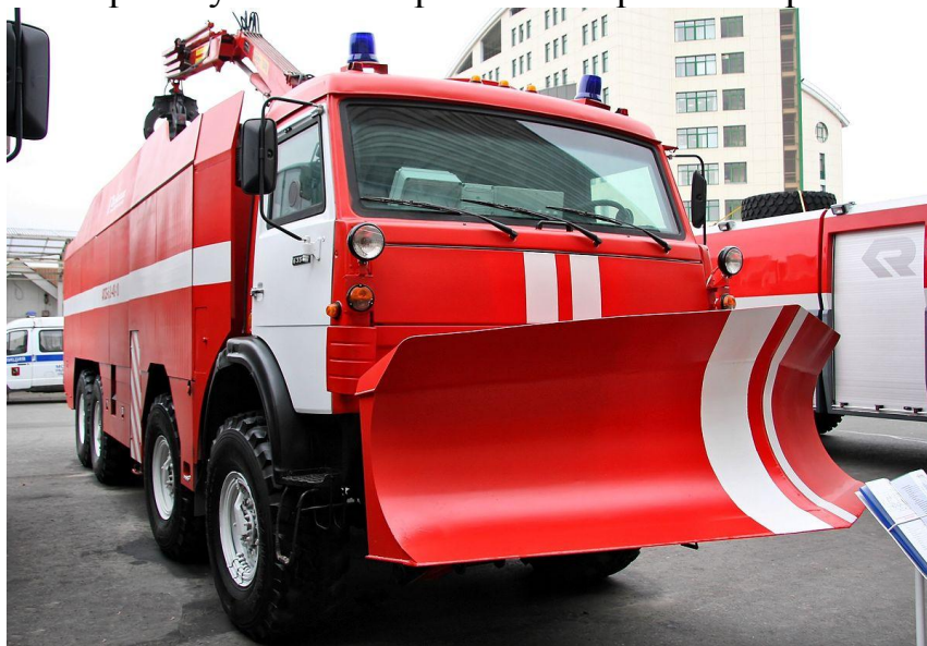
Рисунок 2 – Автомобиль пожарно-спасательный бронированный АПСБ-6,0-40-10(63501)
