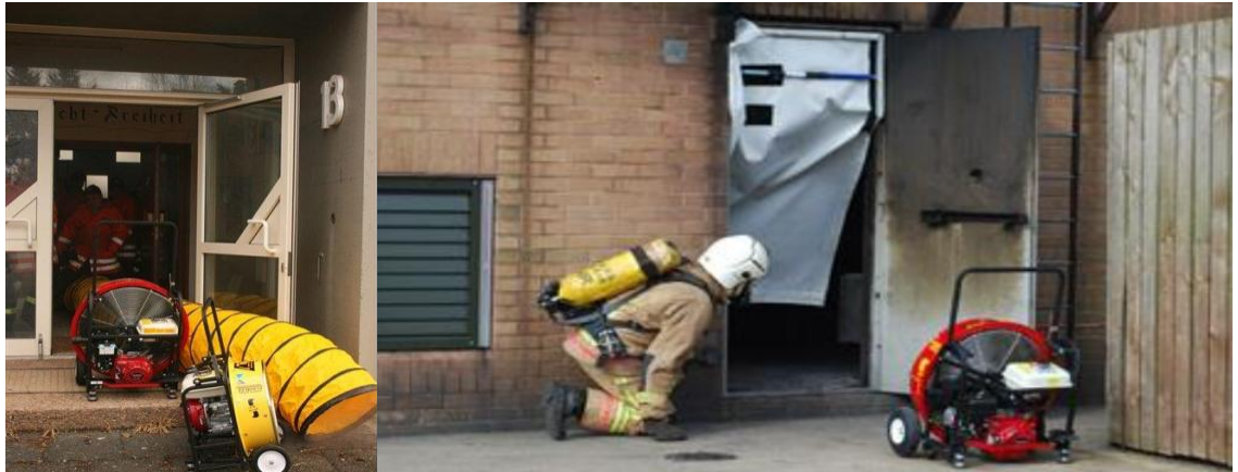
Рисунок 2 – Применения мобильных переносных вентиляторов при осуществлении тактической вентиляции
