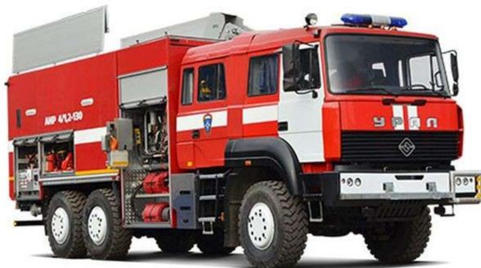
Рисунок 4 – Автомобиль насоно-рукавный АНР-4/1,2-130 (63701)
