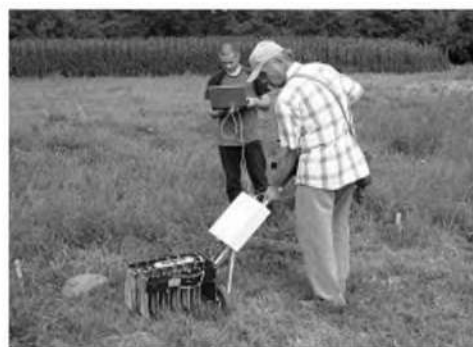
Рис. 1 Исследование поведения антенн в системе. Заложены пластиковые цилиндры d = 13\text{ см} , h = 4.5\text{ см} , наполнение – влажный песок ( \epsilon \sim 6 ).
