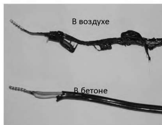
Рисунок 2 – Повреждения изоляции и оболочки жилы кабеля, проложенного в воздухе и в бетоне
