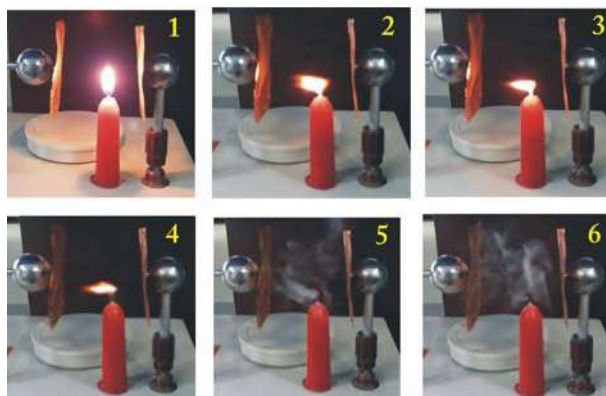
Рисунок 2. – Последовательные фазы процесса по тушению пламени с помощью электрического поля
