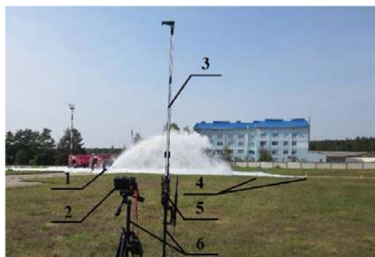
1 – ЛС; 2 – видеокамера; 3 – линейка; 4 – маяки; 5 – анемометр; 6 – штативы Рисунок 1. – Общий вид экспериментальной установки
