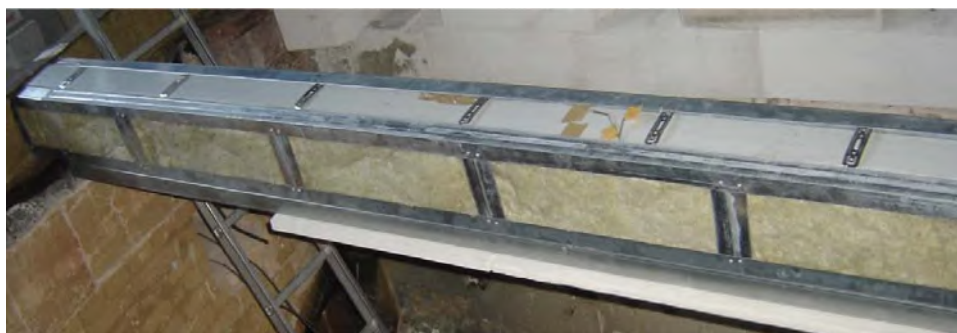
Рисунок 2 – Фрагмент экспериментальных исследований полимерной балки с огнезащитой
