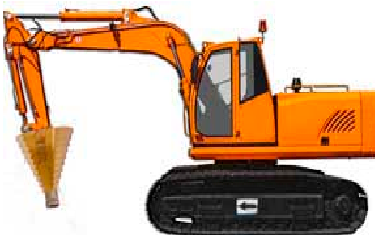
Рисунок 3. Грузозахватное устройство установлено на экскаватор
