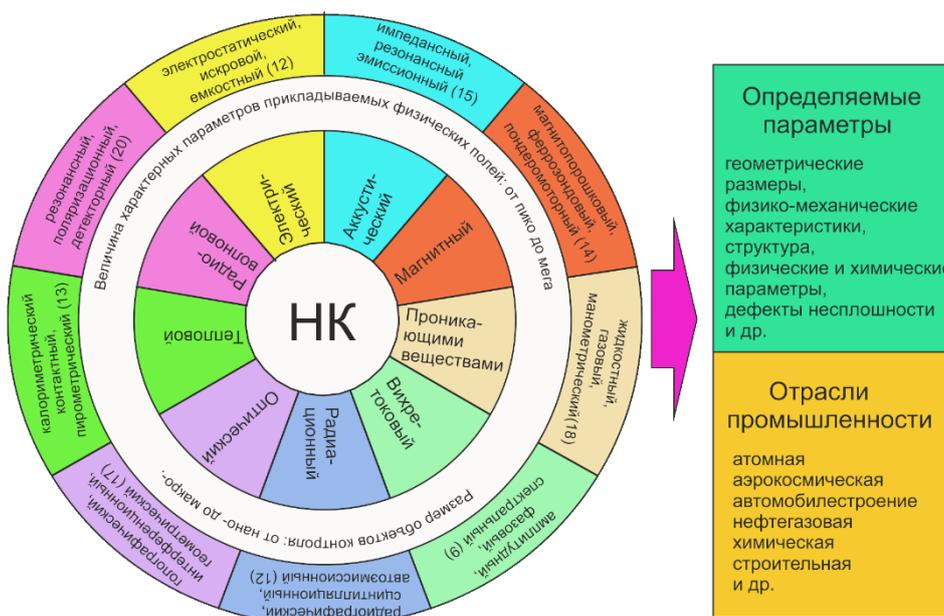
Рис. 1. Схематичное представление о неразрушающем контроле как области науки и техники. В скобках указано общее количество методов контроля, относящихся к определенному виду согласно ГОСТ 18353-79
