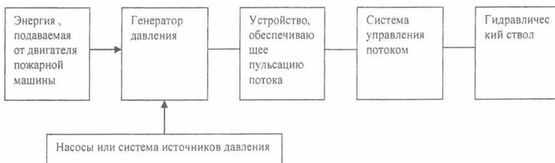
Рисунок - Принципиальная схема системы формирования струйных потоков
