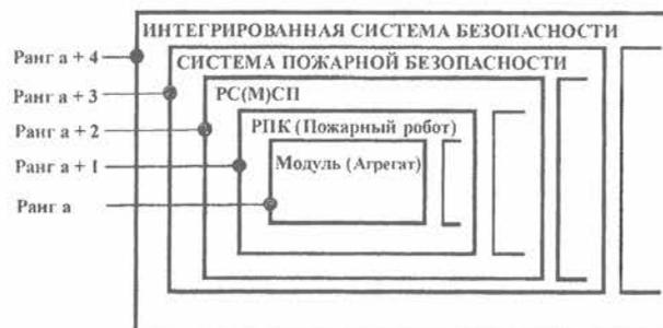
Рисунок 1 - Пример иерархии систем роботизированного пожаротушения
