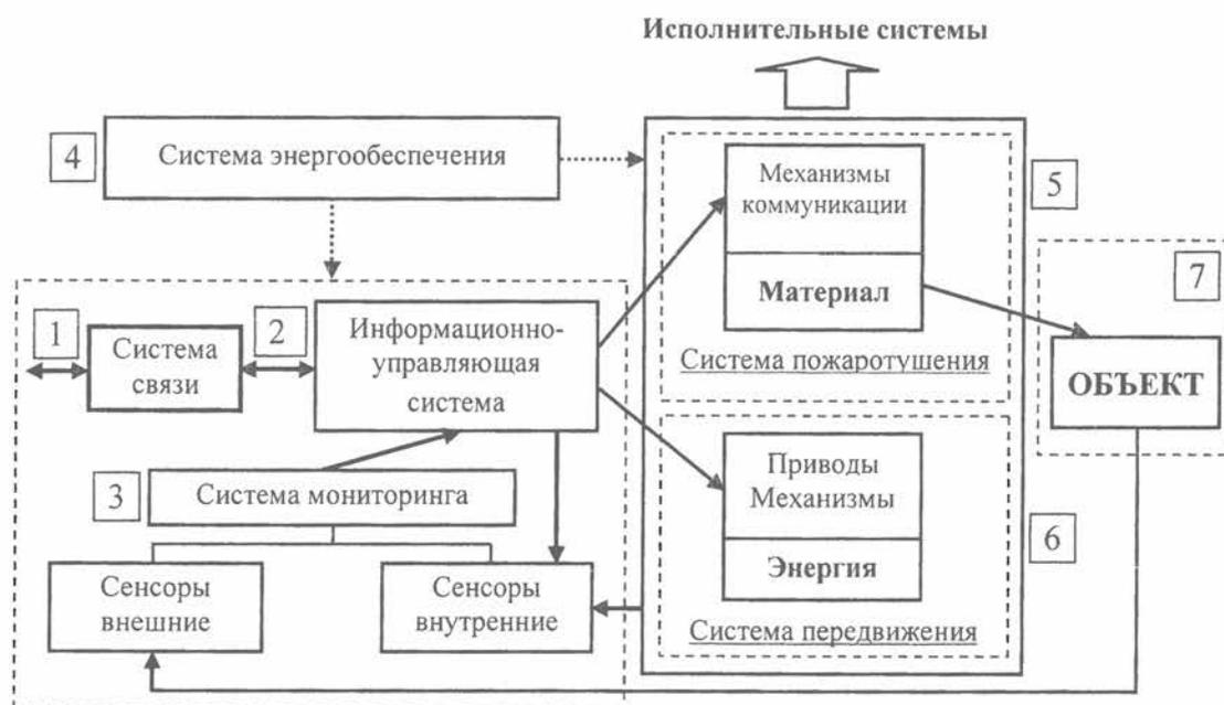
Рисунок 2 – Структурно-функциональная схема пожарного робота
